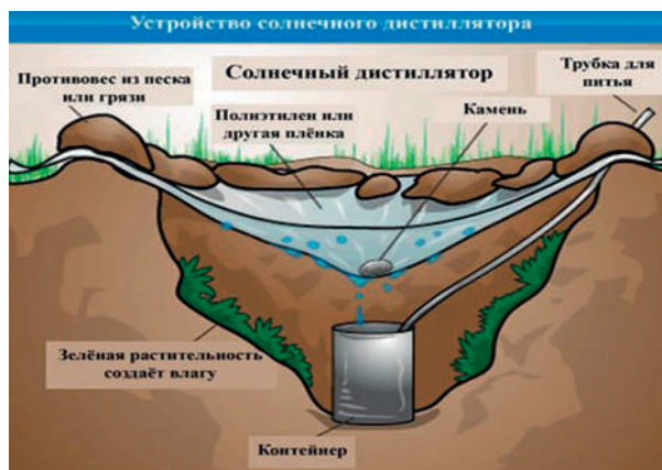
Рис.3. Солнечный дистиллятор
