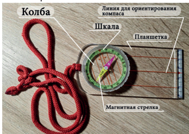
Рис. 2. Устройство компаса (марка Москомпас, модель 22с)
