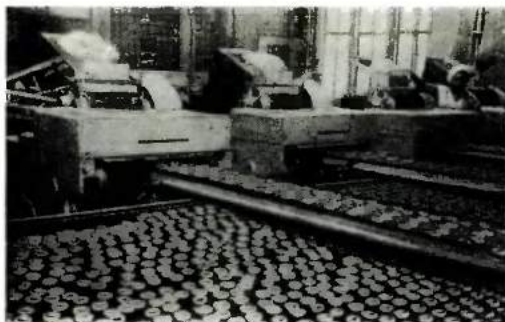
Хлебозавод «Автомат». Механизированная линия выпечки сухарей.
