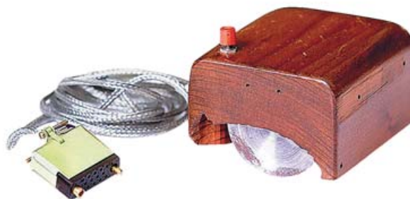
Первая компьютерная мышь. Изготовлена вручную в 1968 году
