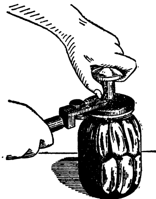
Ручна заковувальна машинка.
