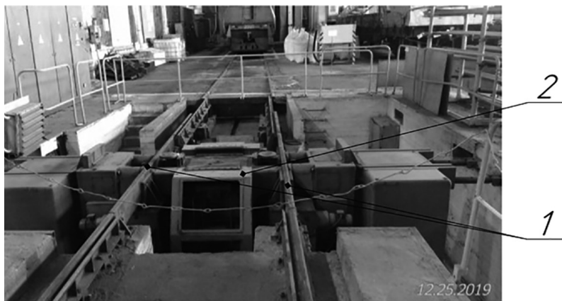
Рис. 14. Общий вид станка UGB-150: 1) собственно станок UGB-150, 2) рельсы для перемещения и позиционирования вагона или локомотива.
