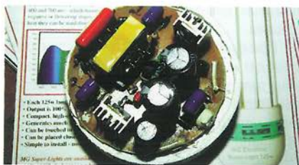
Внутренний электронный балласт для ЭСП — компактной флуоресцентной лампы: небольшой и выделяющий совсем немного тепла.
