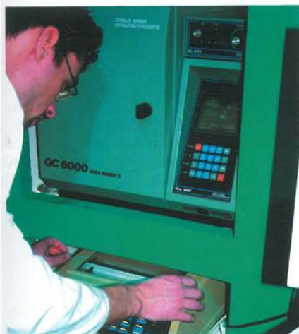
Ученый из компании Саппа измеряет содержание ТГК в шишках с помощью газового хроматографа.
