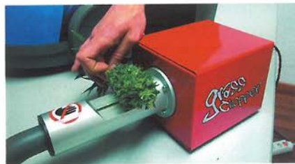
«Grass Chopper» — одна из множества современных машинок для стрижки шишек, использующая пылесос для сбора срезанной листвы.
