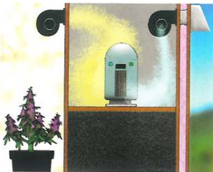
При контакте озона с очищаемым воздухом происходит реакция, при которой молекулы озона O_3 превращаются в молекулы кислорода O_2 .
