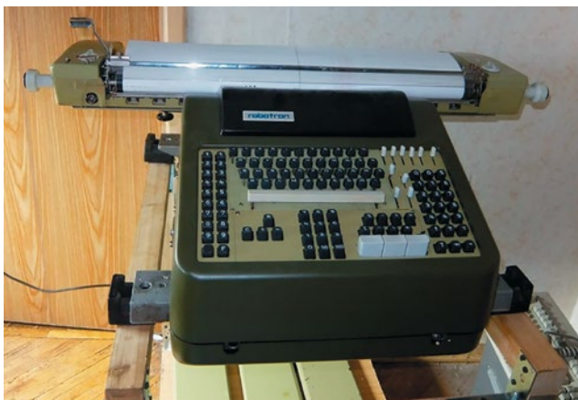
Устройство переноса информации на п/л «Аскота-170»
