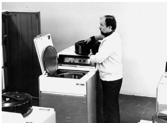
Электронщик Ю. Трофимов устанавливает магнитный диск («кастрюльку»), но это еще светлое будущее 80-х. С такими МД иногда летали в Москву, передать сводную информацию
