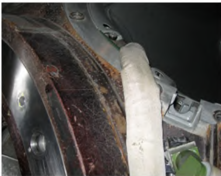
Зона вероятного прогара теплозащиты на космическом корабле «Союз»
