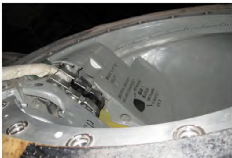
Парашютный контейнер космического корабля «Союз»
