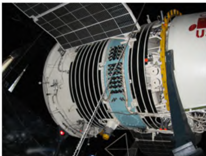
Приборно-агрегатный отсек космического корабля «Союз»
