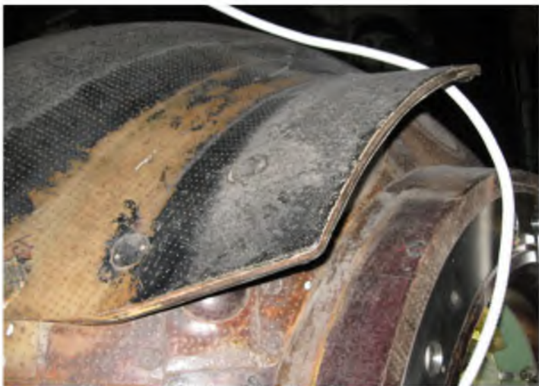
Аэродинамический щиток на спускаемом аппарате космического корабля «Союз»
