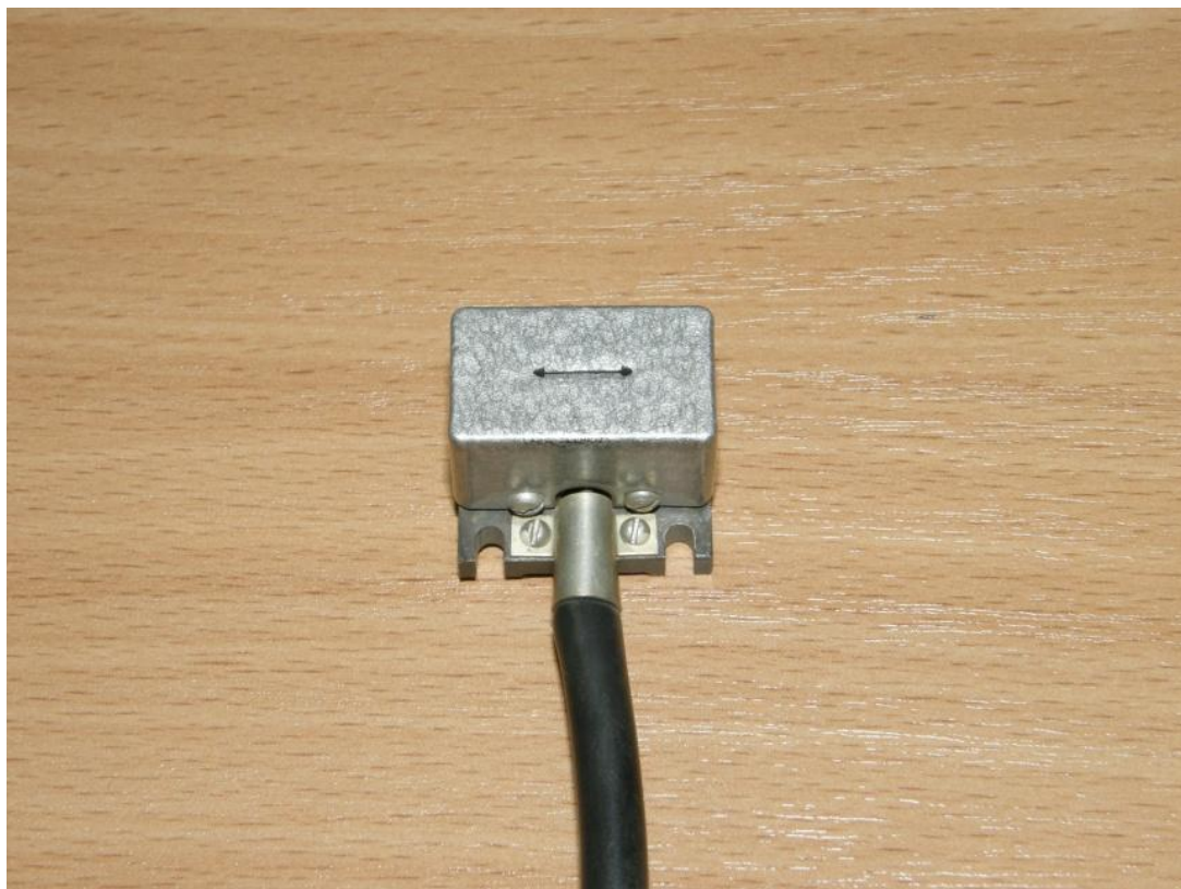
Рис. 3.3. Виброаппаратура ВИБ-6ТН с датчиком виброускорения: а – виброизмерительный прибор, б – датчик ускорения
