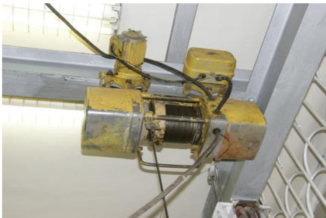
Рис. 3.1. Таль электрическая канатная: а – схема, главный вид; б – схема, вид слева; в – общий вид
