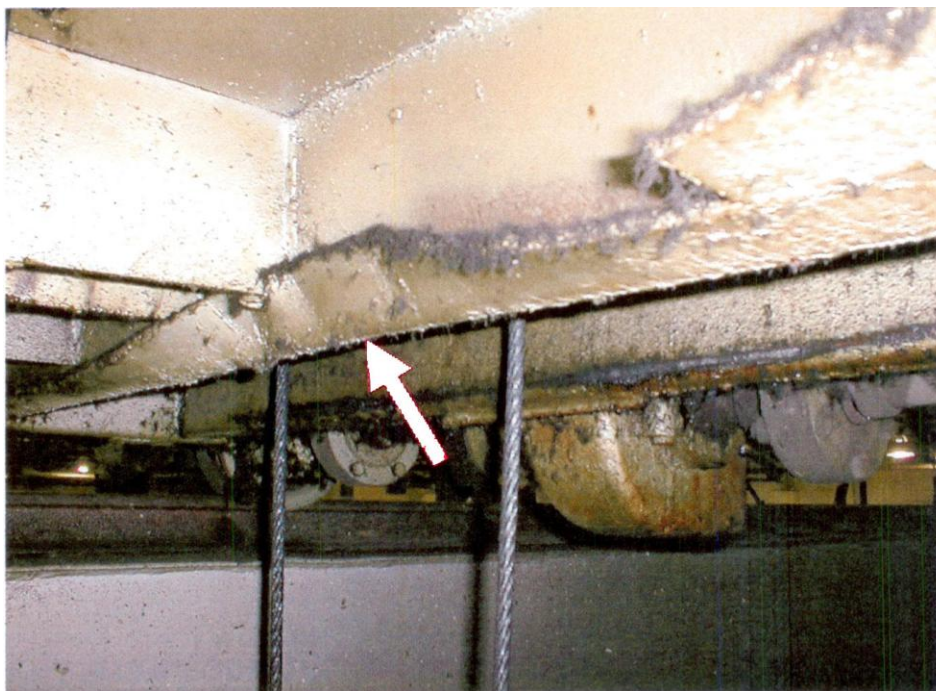
Рис. 1.8. Деформация поперечной балки рамы грузовой тележки от переподъема крюковой подвески
