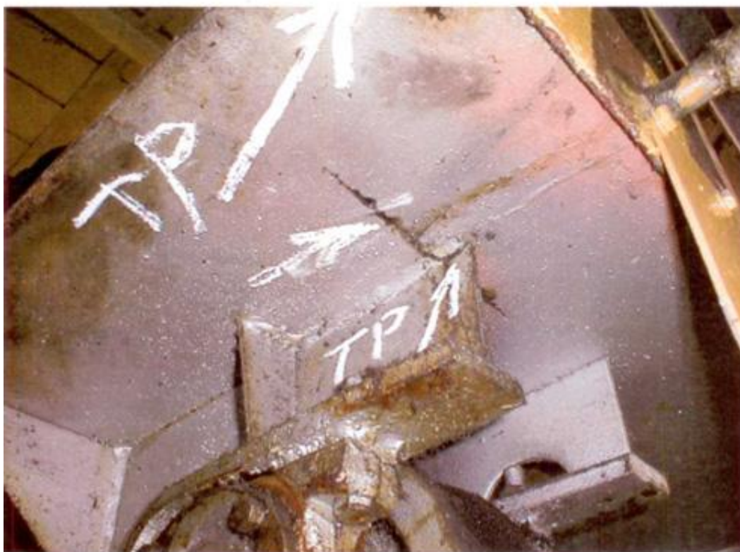
Рис. 1.10. Трещины в околобуксовых зонах на грузовой тележке
