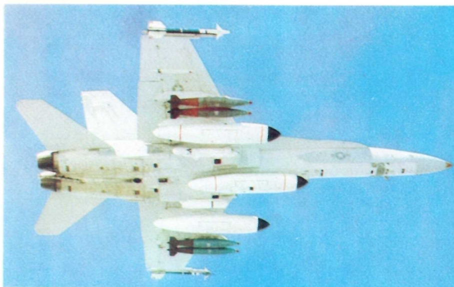
САМОЛЕТ F/A-18 «ХОРНЕТ» — многоцелевой сверхзвуковой самолет. Поступает на вооружение авианосной авиации и авиации морской пехоты США в вариантах истребителя и штурмовика. Носитель ядерного оружия. Радиус действия от 740 до 1020 км. Боевая нагрузка штурмовика (управляемые ракеты и авиабомбы) — 6080 кг. Общая программа поставок — 1377 самолетов.
