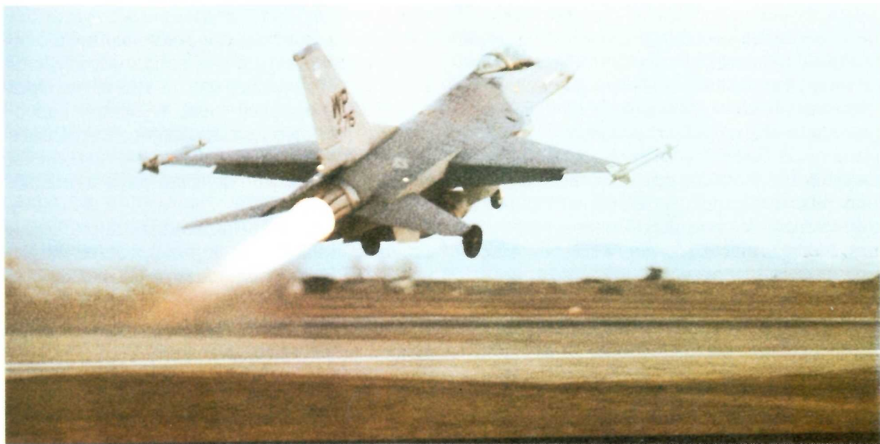
ИСТРЕБИТЕЛЬ-БОМБАРДИРОВЩИК F-16. Радиус действия свыше 1000 км. Носитель ядерного оружия. Максимальная боевая нагрузка (управляемые и неуправляемые ракеты, авиабомбы) — 6700 кг. Поступил на вооружение ВВС США в 1979 г.
