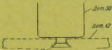
Рис. 19. Вариант соединения поковки коника и полоза (нумерация деталей дана применительно к спецификации ГЗЯ-1)
