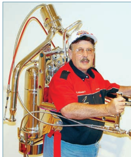
Реактивный ранец, собранный энтузиастом из авиационного алюминия, действительно может летать.
