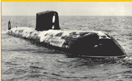
Проект 705 «Лира» и К-278 «Комсомолец» погружались на глубину свыше 1 километра (правда, жесткий корпус после этого приходилось чинить).
