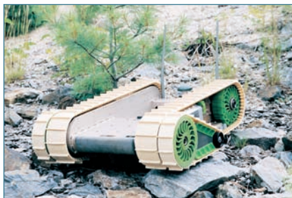
iRobot PackBot используется военными США для безопасного разминирования самодельных взрывных устройств в туннелях и пещерах. Чтобы его остановить, достаточно воспользоваться пультом ДУ... или дробовиком.
