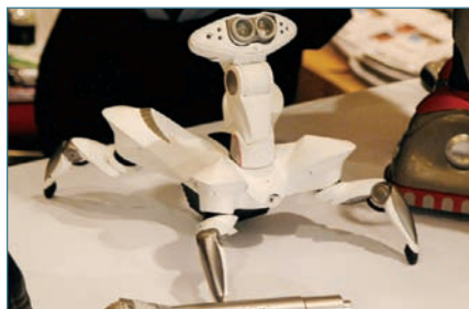
Четвероногий малыш Roboquad передвигается на трех скоростях и запросто обходит любые препятствия. Благодаря множеству датчиков робот отличает картонную коробку от собачьей миски и реагирует на движения и звук с расстояния до 5 метров.
