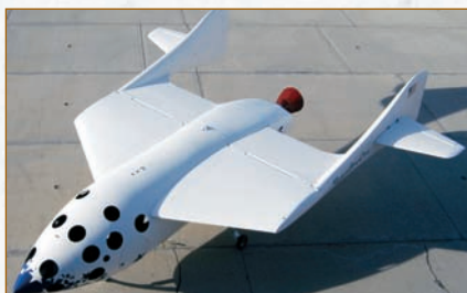
SpaceShipOne. Длина 5 метров, размах крыльев — 5 метров, максимальный вес — 3,6 тонны.
