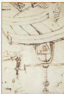
Приспособление для подводных диверсий против судов противника. По сути — «продвинутый» штопор, который вкручивался в доски обшивки и разрывал их.
