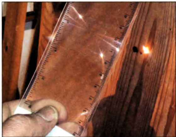
Френелевская линза-линейка фокусирует солнечные лучи не хуже, а даже лучше (потому что она больше) обычной стеклянной линзы. Солнечные лучи, собранные ею, мгновенно поджигают сухую сосновую доску.
