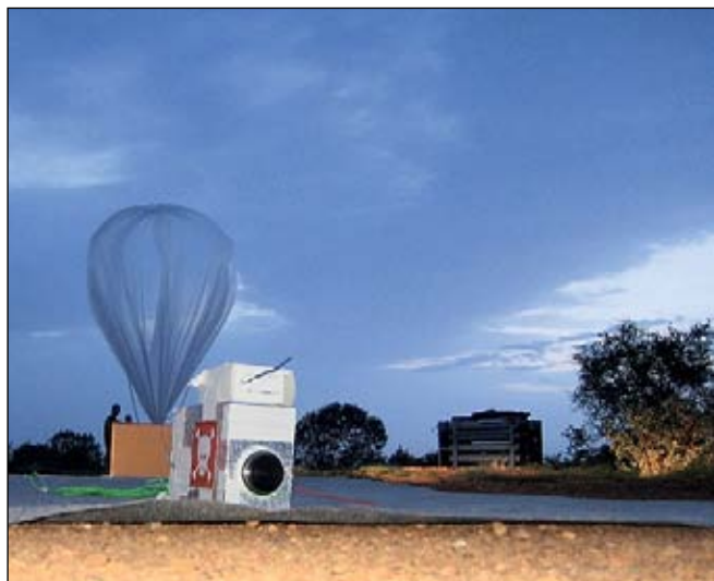
Готовый к запуску флуоресцентный гигрометр в защитном корпусе в составе аэростатного подвеса. Нигер, август 2006 года.
