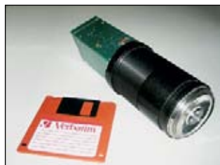
Флуоресцентный гигрометр. Высокая точность и быстрое действие прибора обеспечиваются применением соосной открытой оптической схемы, в которой измеряемый объём располагается снаружи прибора. Водородная лампа (источник измеряемый объём ультрафиолета в приборе), специально разработанная в Государственном оптическом институте, обладает высокими интенсивностью излучения и стабильностью.
