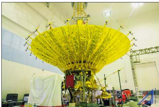
Антенна космического радиотелескопа «Спектр-Р» состоит из 27 лепестков и имеет в разложенном состоянии диаметр 10 м. При выведении на целевую орбиту антенна находилась в сложенном состоянии. Наблюдения на космическом радиотелескопе ведут одновременно на двух диапазонах — 0,3 ГГц и в интервале 18—25 ГГц. Фото: НПО им. С. А. Лавочкина.
