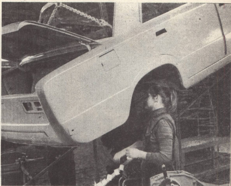
Здесь дно автомобиля покрывают шумостойкой мастикой.
