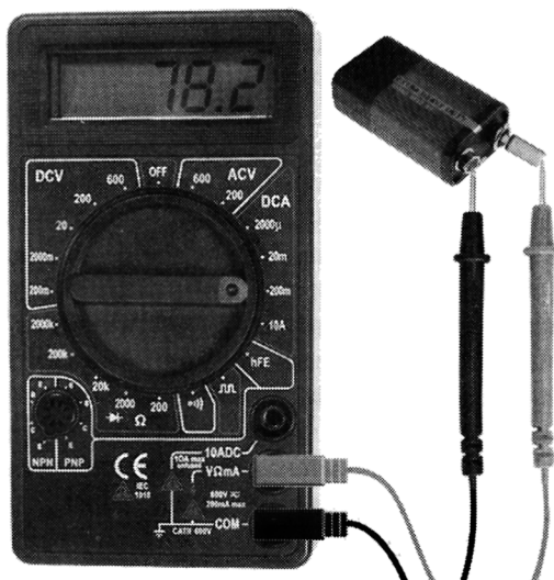
Рис. 2.68. Установка предела измерения тока
