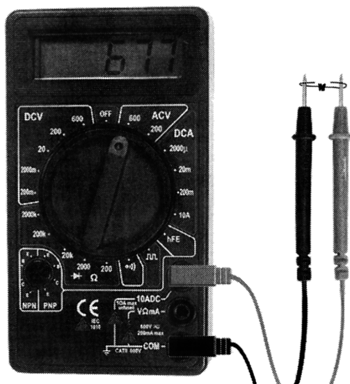
Рис. 2.66. Измерение сопротивления
