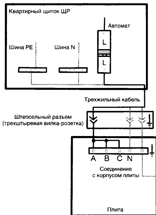
Рис. 2.104. Схема подключения трехфазной плиты в однофазную сеть
