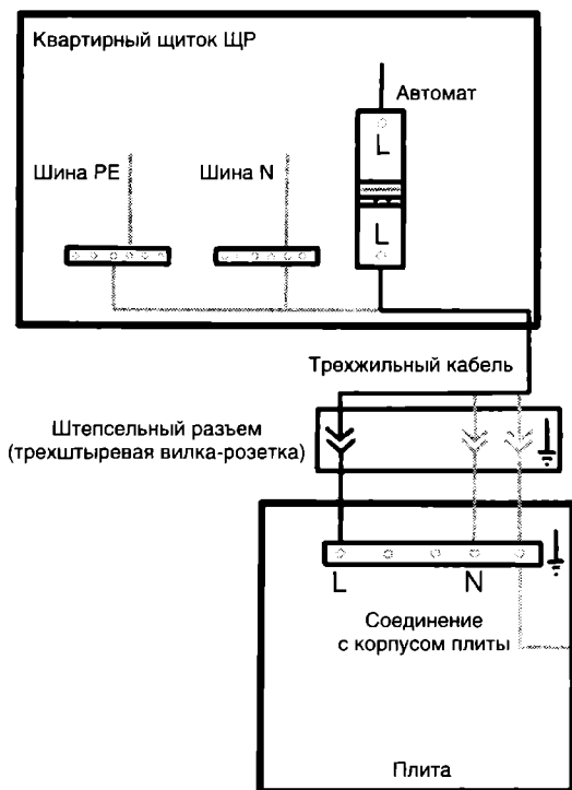
Рис. 2.105. Схема подключения однофазной плиты в однофазную сеть
