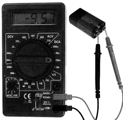
Рис. 2.63. Измерение напряжения элемента питания
