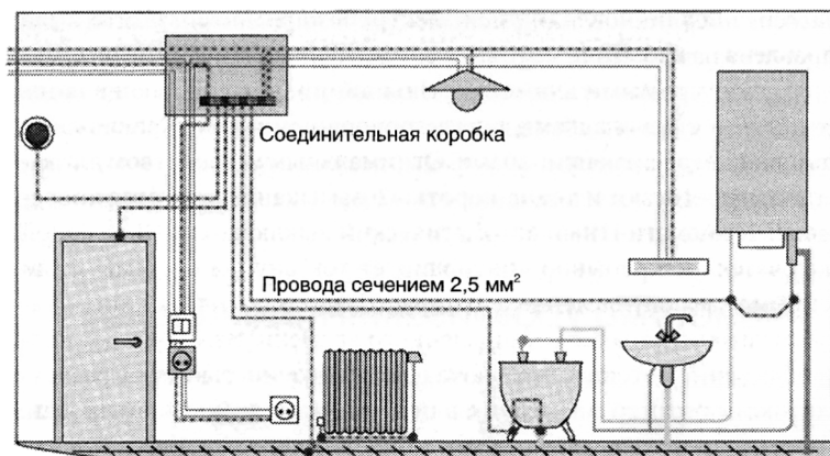
Рис. 2.40. Система уравнивания потенциалов
