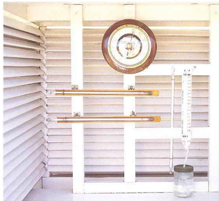
**Домашний пункт метеонаблюдений.** В специально оборудованной деревянной будке размещены барометр-анероид (вверху), сухой и смоченный термометры (справа), горизонтально закреплены максимальный и минимальный термометры (слева). Стены из реек предохраняют приборы от солнечных лучей, но не ограничивают доступ воздуха.
