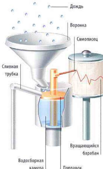
**Плювиограф.** Этот прибор измеряет количество и норму дождевых осадков. Дождь попадает в воронку, стекает в приемную камеру, где находится поплавок, который поднимается.
