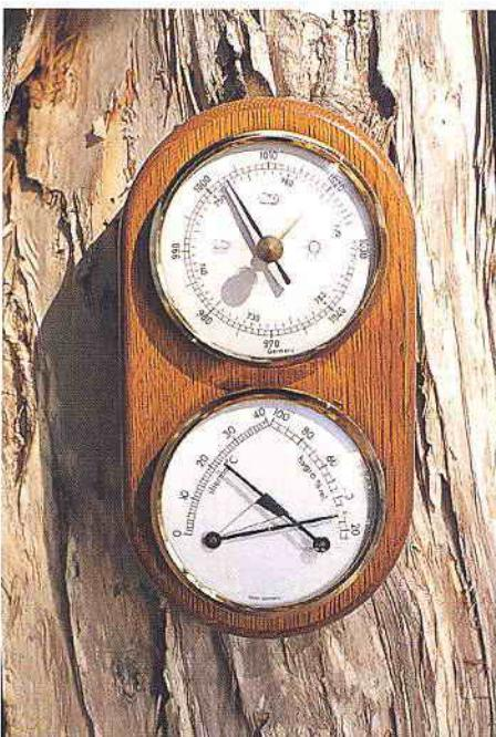
**Три в двух.** У этого прибора два циферблата, но измеряет он три показателя. Вверху барометр-анероид для измерения давления, внизу термометр и гигрометр, показывающие температуру и влажность.
