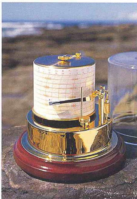
**◀ Барограф.** Это сложный метеорологический прибор, который измеряет и записывает изменения атмосферного давления. Точность показаний зависит от качества изгото-вления прибора. Самописец прикреплен к стрелке, и изменение давления фиксируется в виде сплошной линии на разграфленной ленте, кото-рая закреплена на врачающемся барабане.
