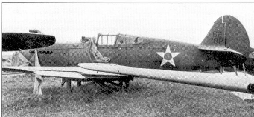
Поврежденный на земле Р-40С из 18th PG ожидает своей очереди для ремонта. Обратите внимание на многочисленные пробоины от осколков. Самолет имеет стандартные опознавательные знаки.
