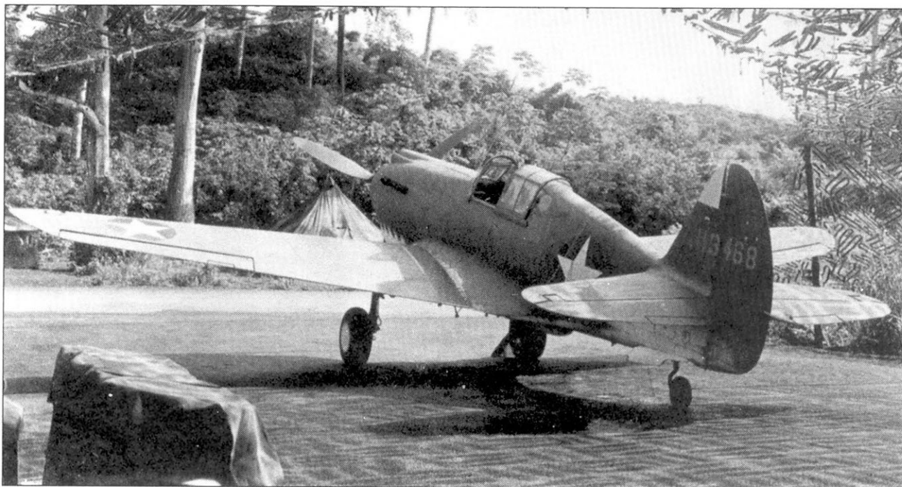
P-40C-CU (41-13468) из 31st FS, 6th AF, Центральная Америка, декабрь 1942 года. Нижние поверхности самолета выкрашены белой краской. Такой камуфляж применялся на самолетах, летавших над морем. Белая четверть на киле - характерное обозначение машин из 6th AF.
