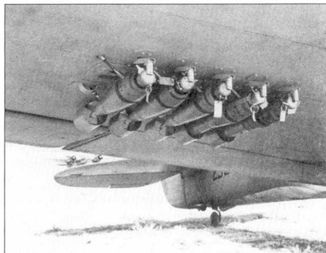
Пять осколочных 25-фунтовых (11,3 кг) бомб под крылом. Это была английская модификация.
