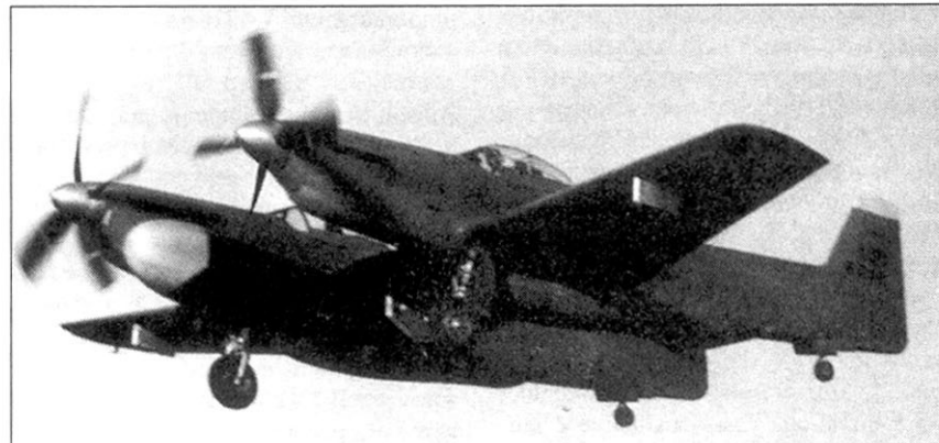
P-82G (46-392) с контейнером, в котором находится радар. Носовой обтекатель контейнера сделан из диэлектрика, который не мешает работе радара.
