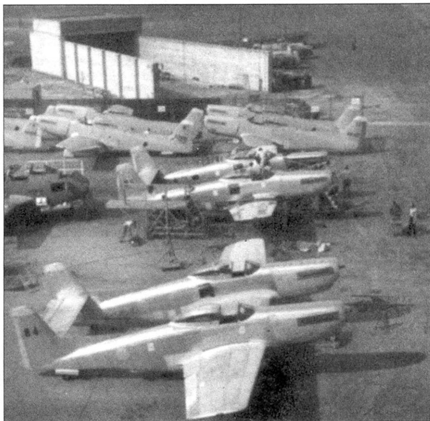
Производство завода в Инглвуде, 1948 год. Под открытым небом идет сборка шести F-82E. Четыре машины на заднем плане целиком покрыты грунтовкой Zinc Chromate, два истребителя на переднем плане загрунтованы лишь частично. На этой же сборочной линии видны два палубных истребителя FJ-1 «Fury». Вдали виднеются два готовых F-82E, три T-6G «Texan» для Бразилии и один FJ-1 «Fury».
