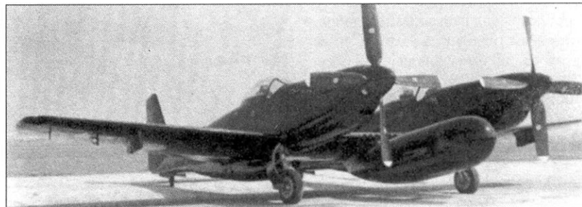
F-82F с контейнером APG-28. Выхлопные патрубки оснащены пламегасителями, необходимыми для ночного истребителя.
