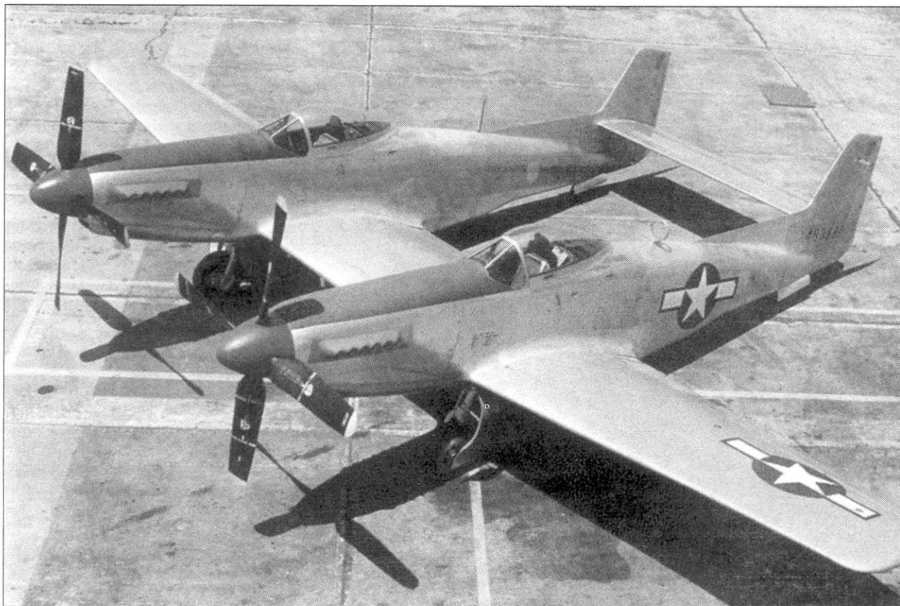
Второй XP-82 (44-83887) в Инглвуде, август 1945 года. Винты вращаются в разных направлениях, что видно по углам атаки лопастей.
