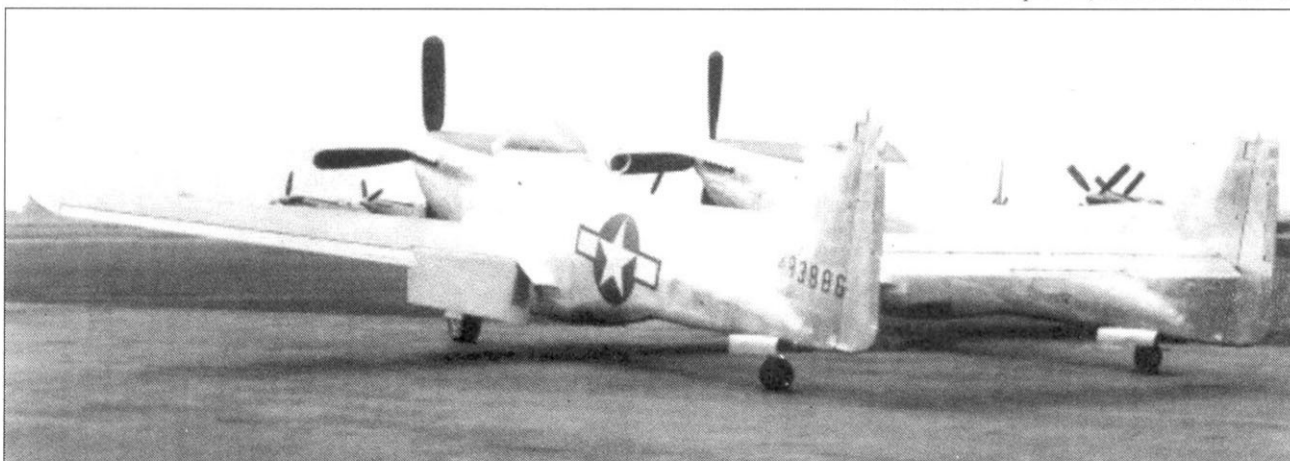
Этот же самолет до устранения проблемы, о чем свидетельствует угол атаки обоих винтов.
