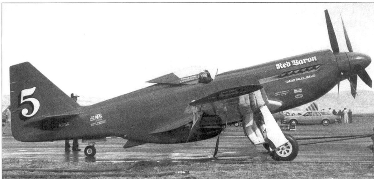
«Red Baron» - целиком выкрашенный в красный цвет «Мустанг», приспособленный для постановки рекордов скорости. Машина оснащена двигателем Rolls-Royce «Griffon» мощностью 3400 л.с. Пилот Мак Маклейн. На соревнованиях Reno Championship Race самолет развил скорость 687,5 км/ч (427,3 миль/ч), уступив пальму первенства Дэррилу Гринеймиру на Grumman Bearcat «Conquest I», разившему 776,28 км/ч (482,46 миль/ч).
