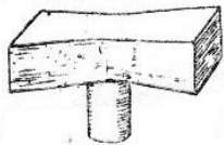
Медная скоба для соединения строительных конструкций
