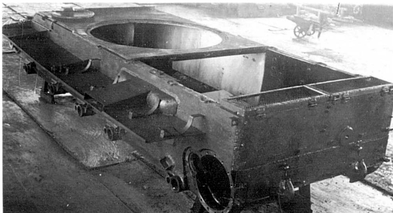
Бронекорпус танка Т-44А в цеху завода № 183. Нижний Тагил, июль 1944 года (ЦАМО).
