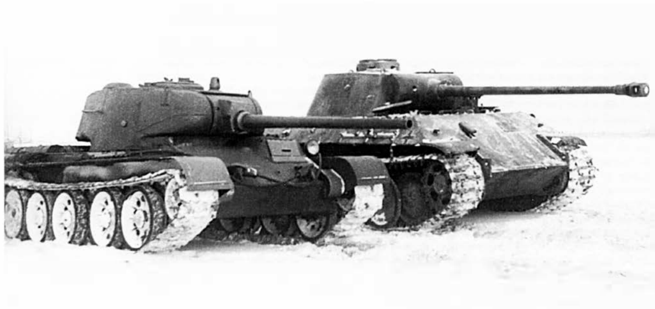
Второй опытный образец танка Т-44 (с 85-мм пушкой) и трофейная «Пантера» Ausf. D. Зима 1944 года. Хорошо видно, что «сорокчетверка» значительно ниже, чем немецкая машина (РГАЭ).
