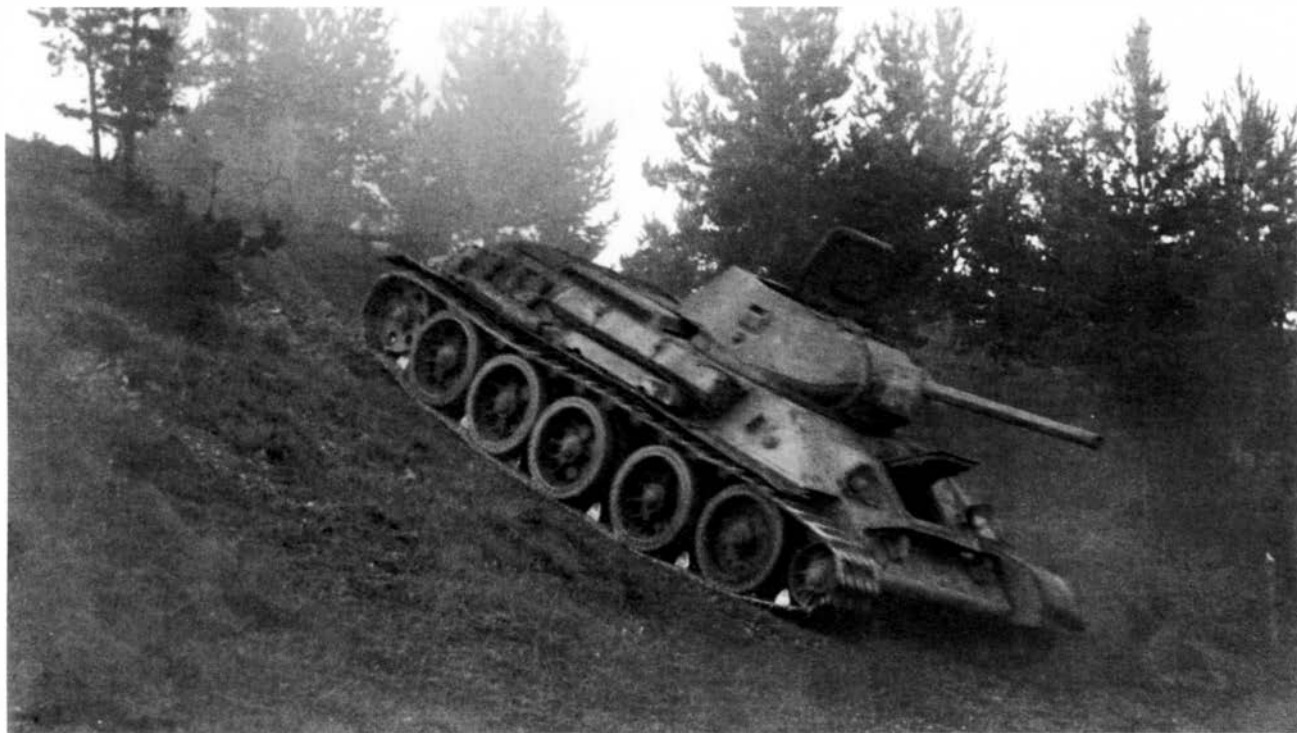
Испытания танка Т-34 с 5-скоростной коробкой перемены передач: на фото машина преодолевает подъем в 33 градуса. Лето 1942 года (ЦАМО).
