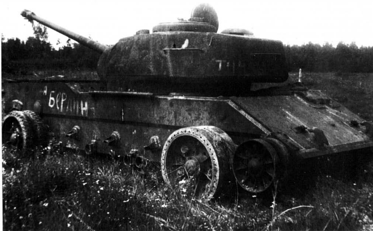
Бронекорпус танка Т-44 второго варианта перед проведением испытаний обстрелом, вид спереди справа. Июль 1944 года (ЦАМО).
