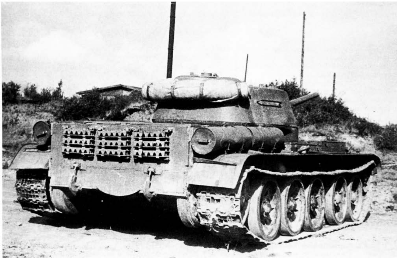
Танк Т-44 второго варианта, вид сзади справа. Лето 1944 года. На кормовом листе закреплены дополнительные «шпоры» (РГАЭ).
