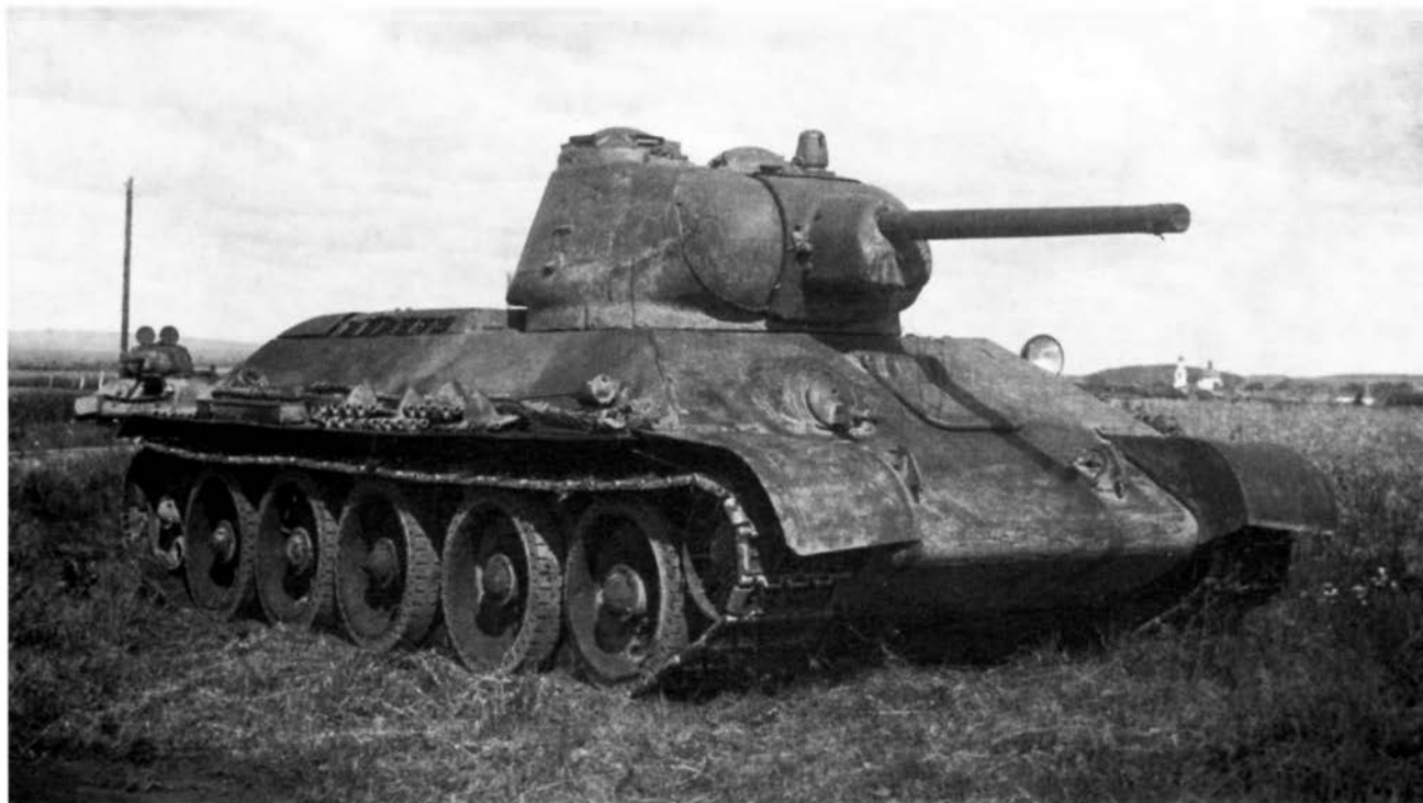
Танк Т-34 с новой трехместной башней, оснащенной командирской башенкой, общий вид. Август 1942 года (ЦАМО).
