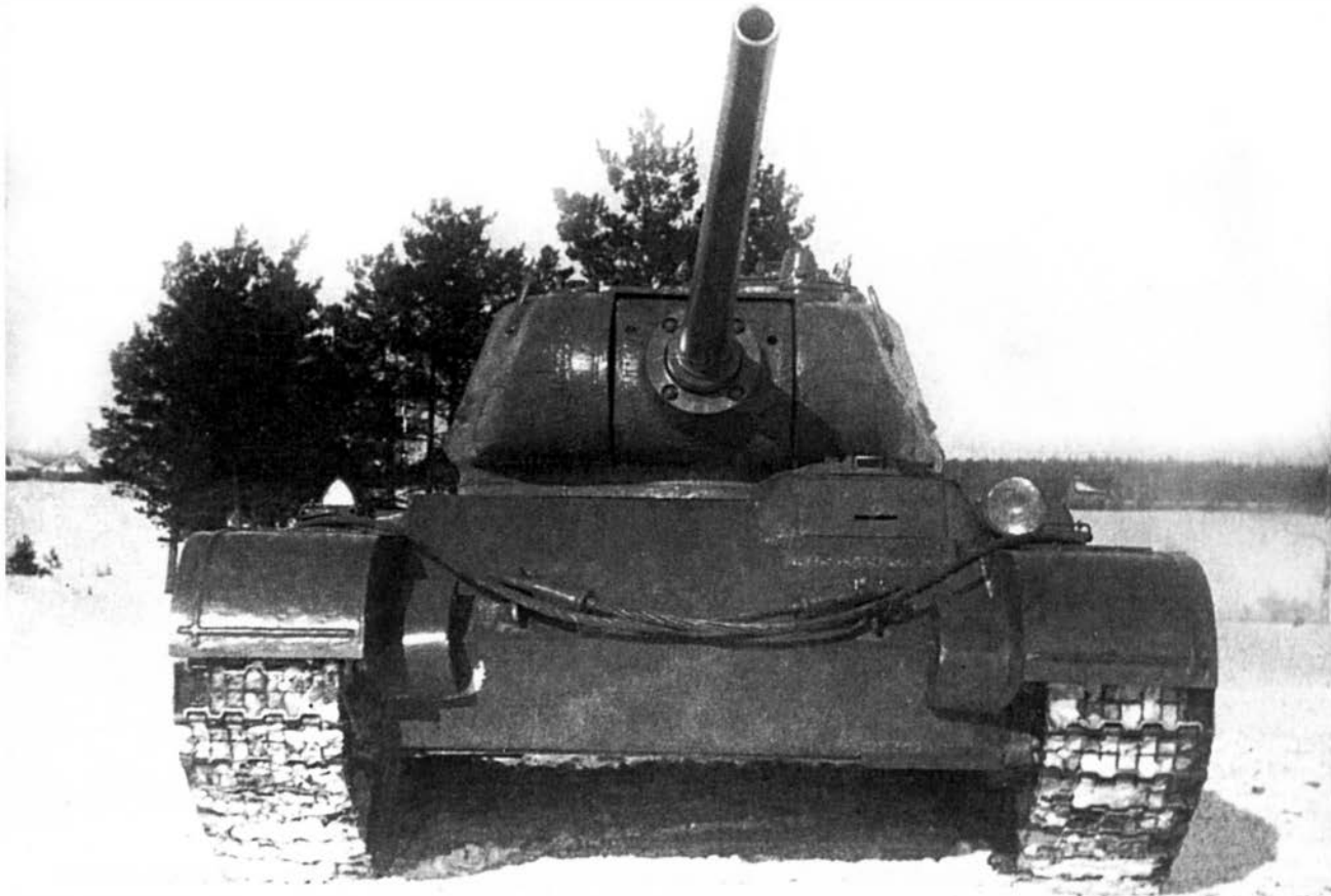
Первый образец танка Т-44 во время испытаний, вид спереди. Зима 1944 года. Хорошо видна рубка механика-водителя (ЦАМО).
