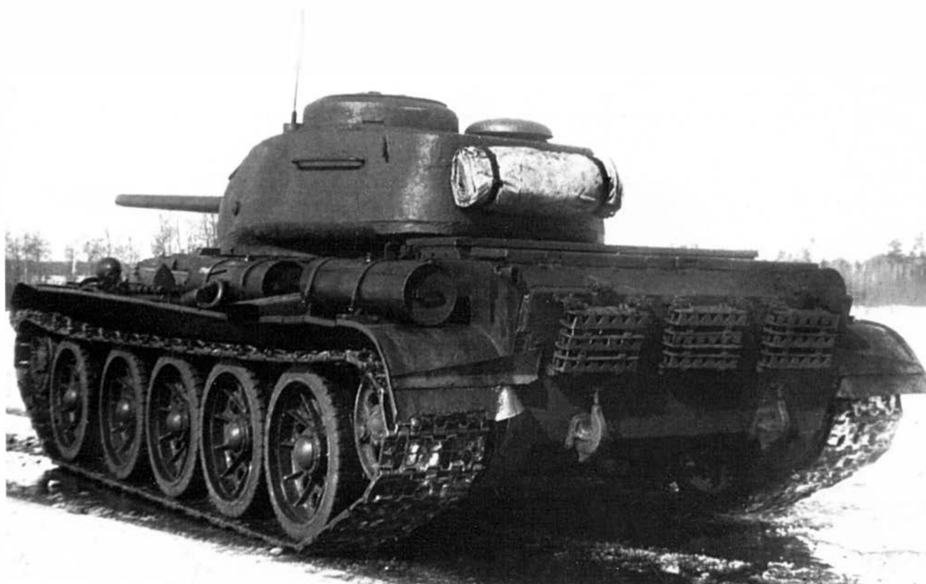
Танк Т-44А, вид сзади слева. Январь 1945 года. На кормовом листе корпуса закреплены шпоры, которые крепятся на траках гусениц (ЦАМО).
