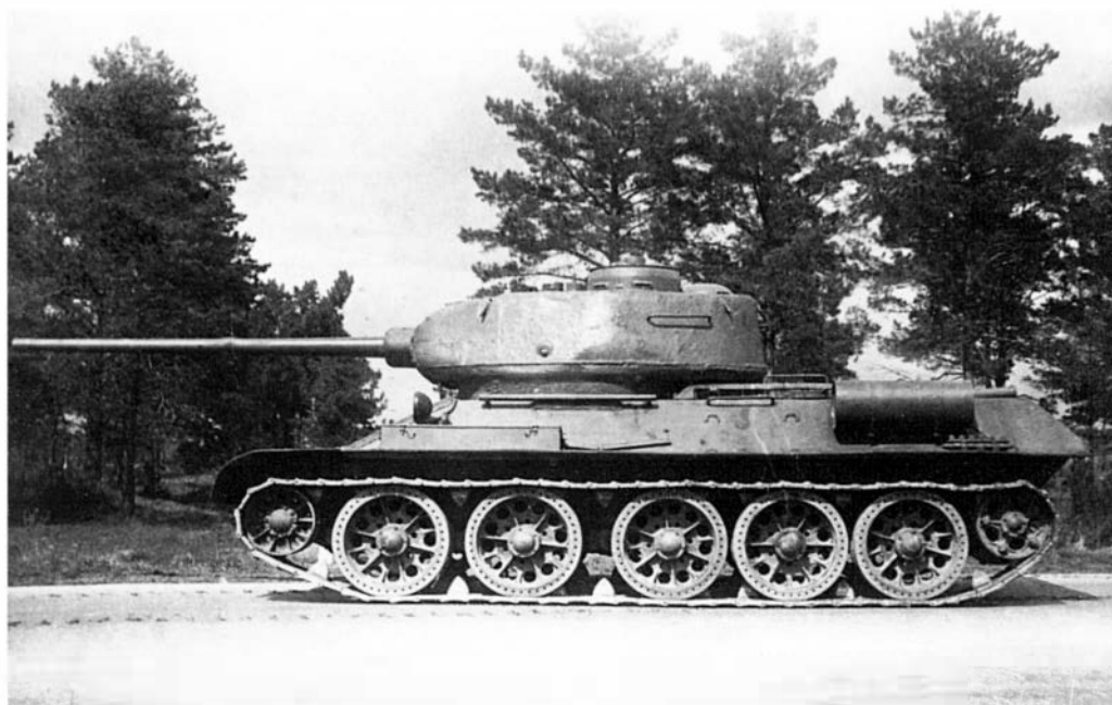
Танк Т-34-85М второго варианта с усиленным бронированием лобовой части корпуса и перенесенными в корму топливными баками, вид слева. Май – июнь 1944 года (ЦАМО).
