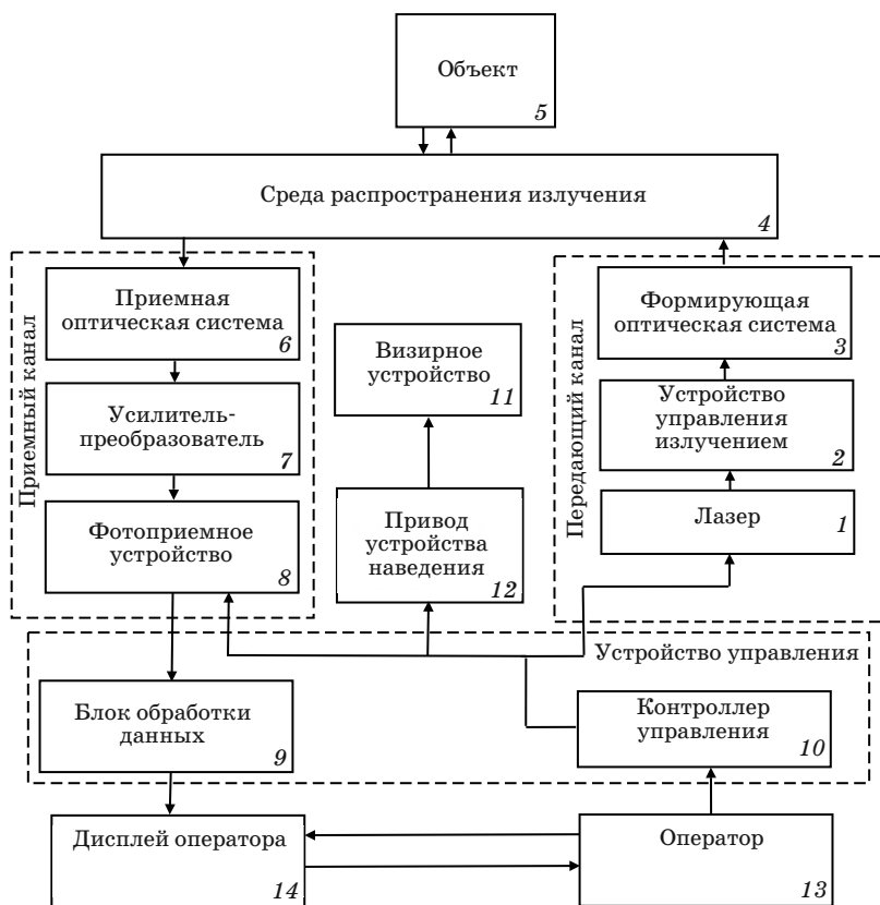
Рис. 14. Обобщенная структура лазерной системы видения
