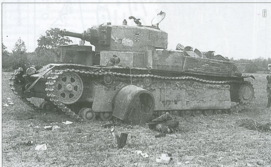
6. Подбитый немецкими войсками средний танк Т-28 из состава 15-го механизированного корпуса РККА. Танк оснащен 76,2-мм пушкой Л-10. Вероятно, танк был подбит в результате атаки с воздуха. Западная Украина, июнь 1941 года (Bundesarchiv).
