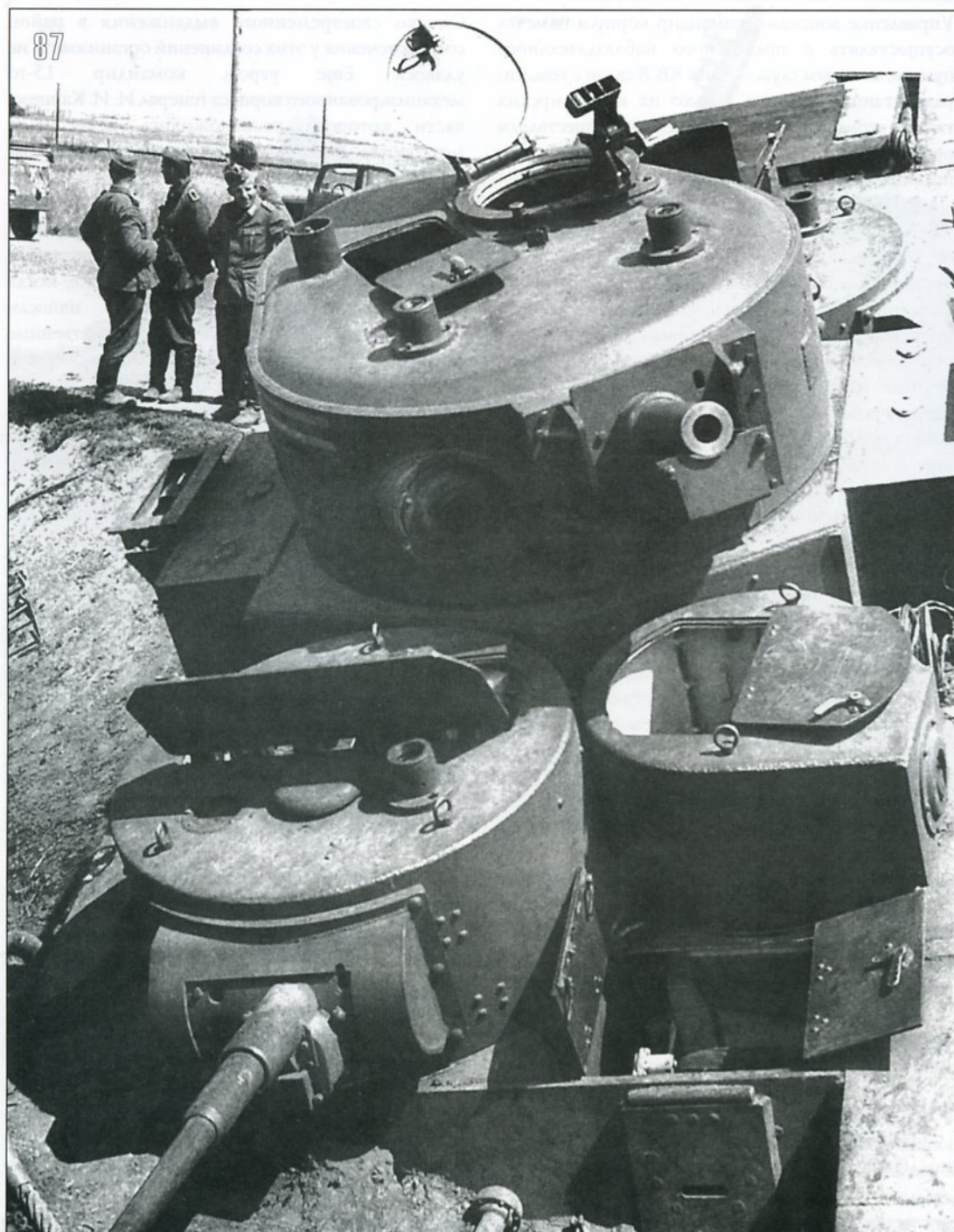
87. Тяжелый танк Т-35 выпуска 1938 года (он же на фото 82, 83, 85, 86), брошенный экипажем из-за поломки. Пулеметные башни танка имеют дополнительную бронезащиту шаровой установки. На главной башне танка видны следы модернизации: стойки поручневой антенны срезаны и заварены, смонтирована штыревая антенна. На башне видны знаки тактической идентификации 67-го танкового полка 34-й танковой дивизии. Юго-Западный фронт, июнь 1941 года (АВЛ).
