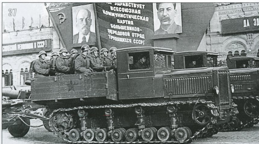
37, 38. Гусеничные тягачи "Коминтерн" буксируют 122-мм пушки А-19 образца 1937 года, которая состояла на вооружении корпусных артиллерийских полков РККА. Москва, 7 ноября 1939 года (АВЛ).
