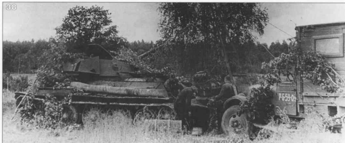
38,39. Подготовка к отражению предстоящего наступления немецких войск. Советские танкисты 2-й танковой армии ремонтируют танки Т-34 в полевых условиях. Один из танков Т-34 (фото 38) экранирован дополнительной броней. Орловско-курское направление, июль 1943 года (АВЛ).
