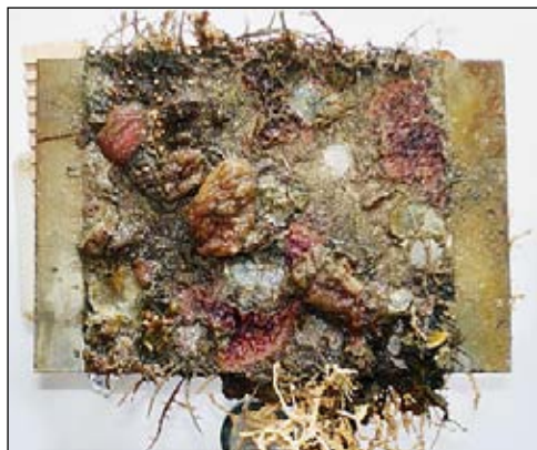
Обрастание водорослями, моллюсками, кораллами усиливает процессы коррозии.
