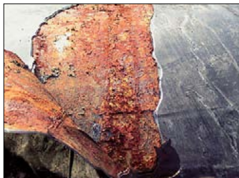
Коррозия магистрального газопровода Газпрома в районе Перми под отслоившимся изоляционным покрытием.
