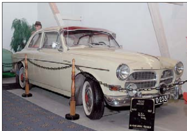
VOLVO Amazon — первый автомобиль, на который ремни безопасности устанавливали серийно.
