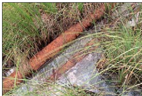
Коррозия трубопровода ТНК-ВР в Тюменской области.
