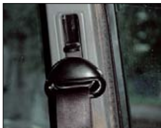
Во многих современных машинах крепление плечевой ветви ремня поддаётся регулировке. На снимках: три положения верхней точки ремня в автомобиле УАЗ Патриот.
