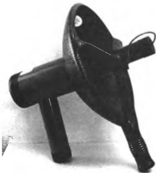
Рис. 26.1. Ультразвуковой микрофон с параболическим отражателем
