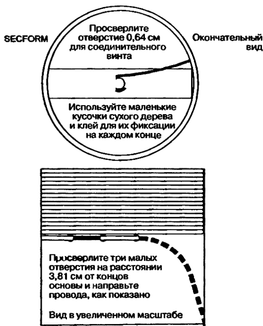
Рис. 14.4. Вторичная обмотка катушки Тесла
