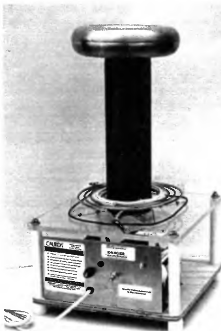
Рис. 14.1. Катушка Тесла, вырабатывающая искровой разряд длиной 30 см
