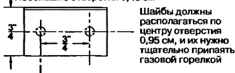
Рис. 18.7. Изготовление искрового разрядника
