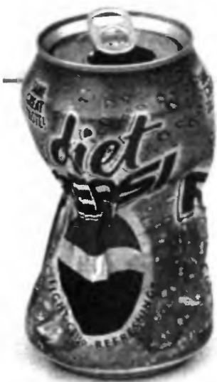
Рис. 7.1. Банка, сжатая в середине магнитным воздействием
