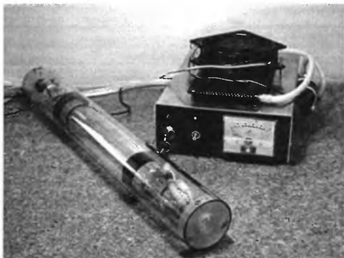
Рис. 8.1. Газовый лазер на углекислом газе CO 2 для лабораторного применения
