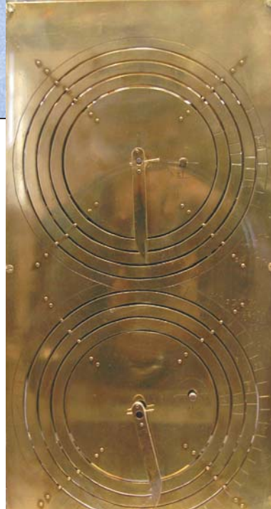
▲ Реконструкция антикитерского механизма. Считается, что это был календарь и навигационный прибор.
