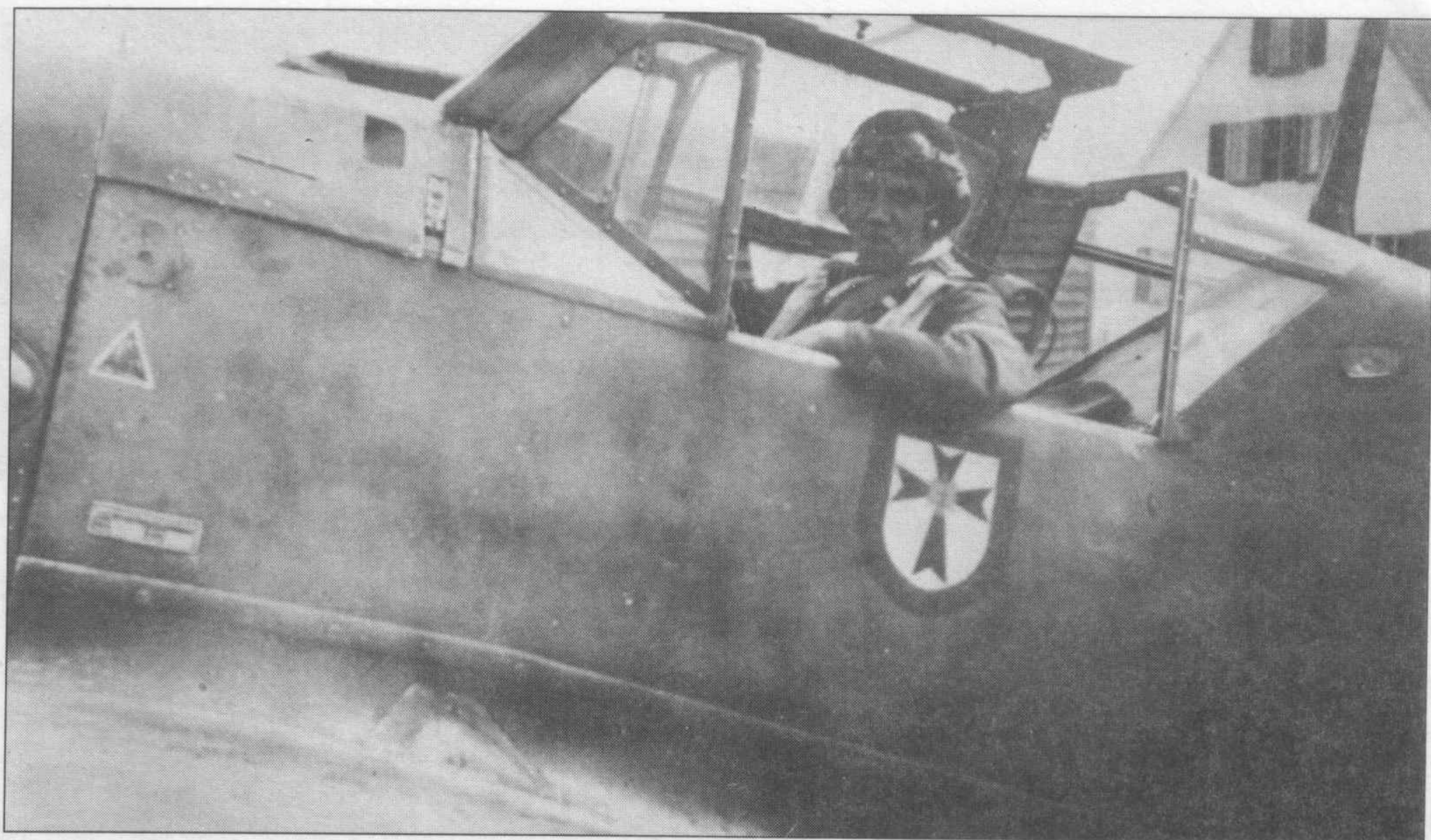
Этот E-4 из JG 1 оснащен накладным лобовым бронестеклом. Над головой пилота видна небольшая ручка, с помощью которой можно было открыть форточку.
