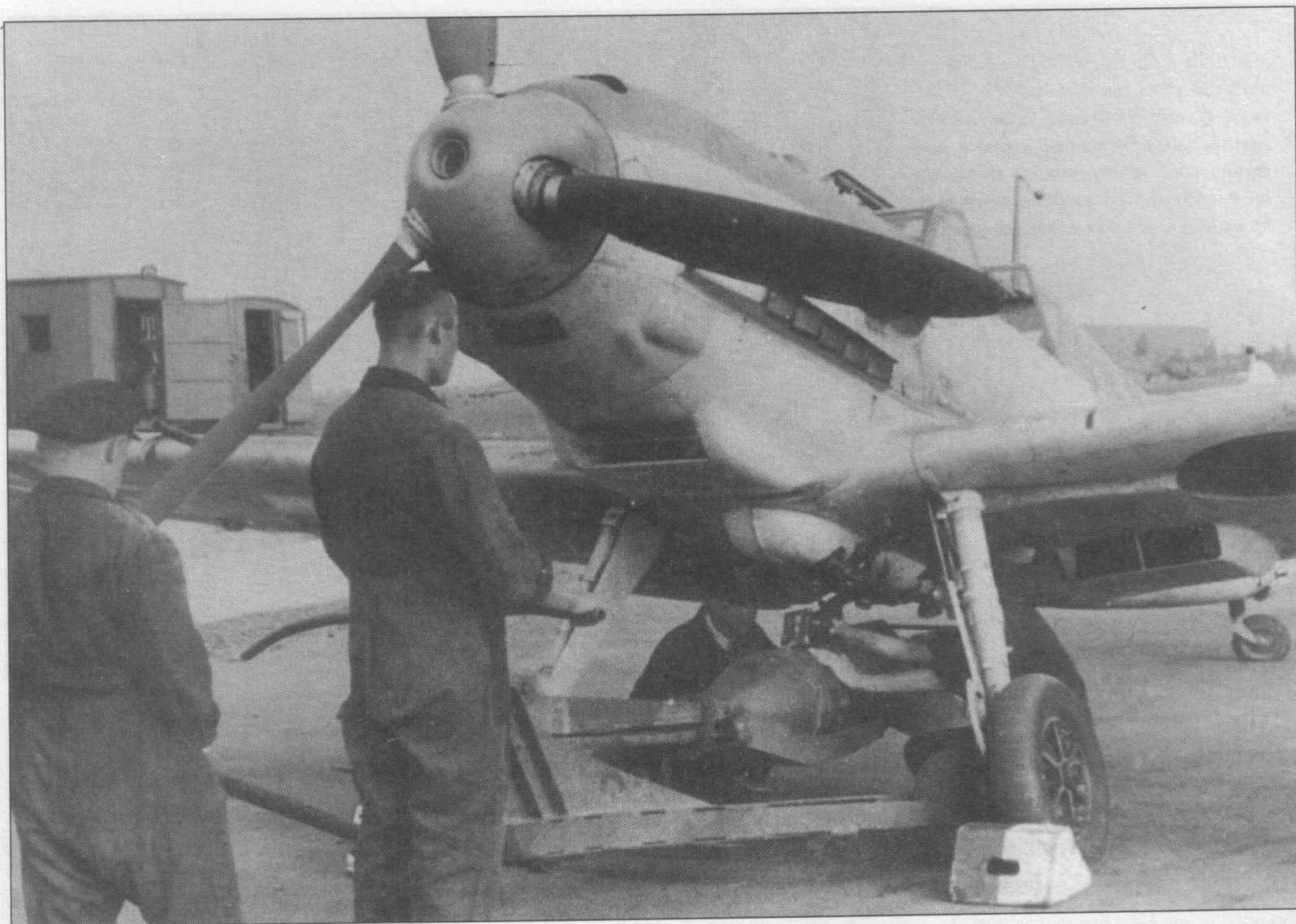
Два снимка, сделанных в ходе подвешивания 250-кг бомбы на пилон ETC 500. Me 109E мог брать в перегруз 500-кг бомбу, но эту возможность очень редко практиковали из-за слишком большой перегрузки машины.
