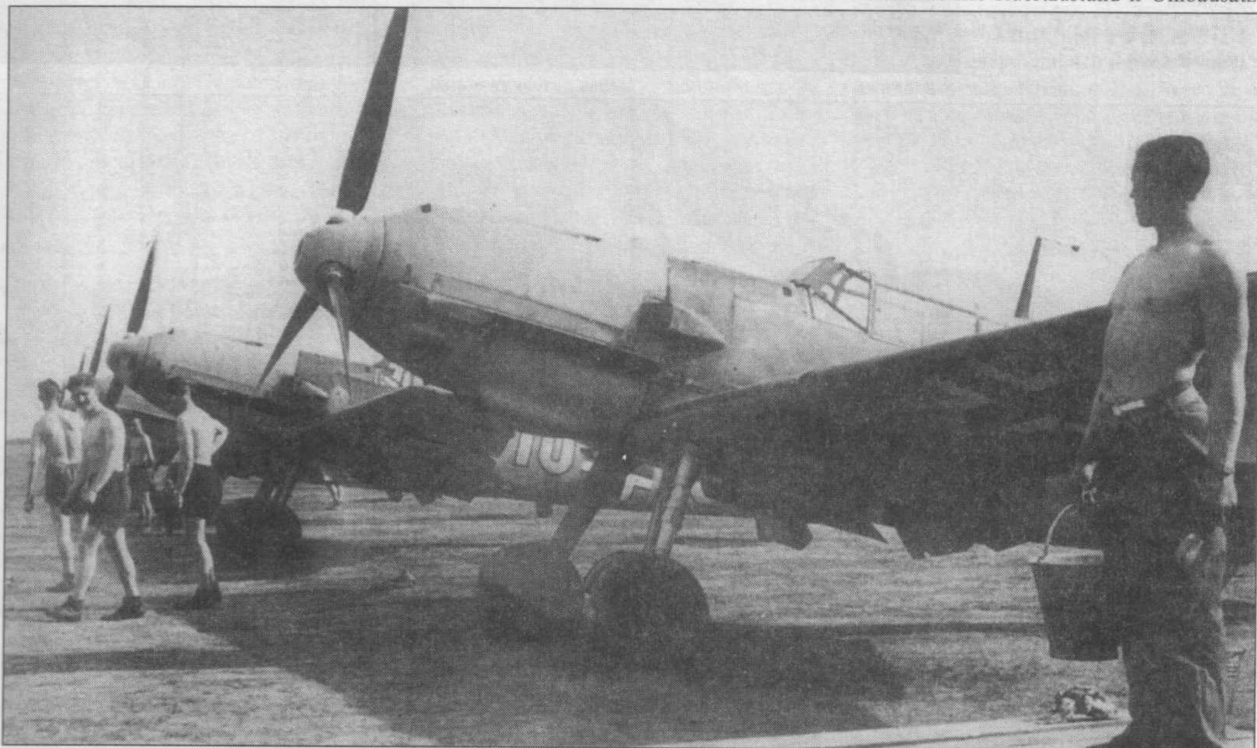
Ряд Me 109E-1 поздней серии, снимок сделан на базе 9./JG 52 в Голландии, 1941 год. Самолет уже имеет бронированную кабину. Воздухозаборник радиатора без «поперечины». Обратите внимание на окраску капота: радиатор выкрашен краской RLM 76, а остальная часть капота желтым. Верхушка обтекателя втулки винта светло-желтого цвета.
