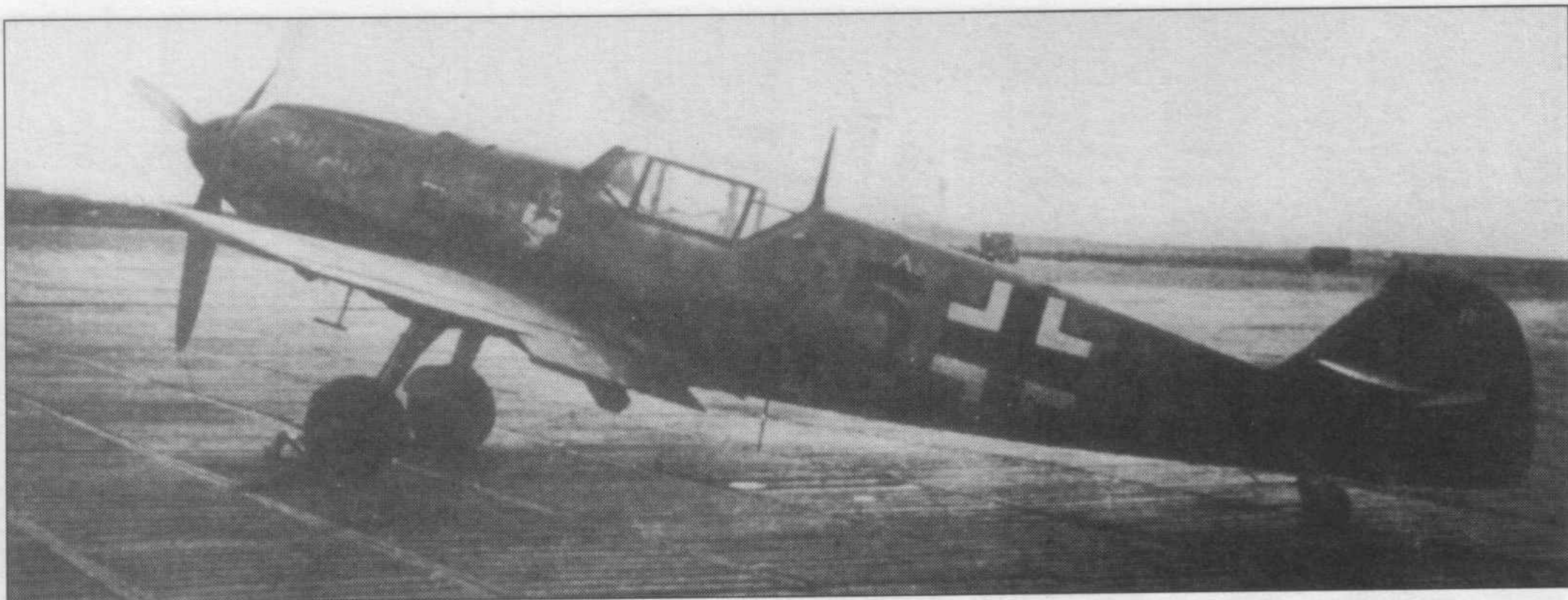
Me 109T-2 из 2./JG 77 на деревянной взлетной полосе в Листере, осень 1941 года. На капоте видна надпись «See Adler», у кабины эмблема части, на на хвостовом оперении две отметки о воздушных победах. Обратите внимание на антенну FuG 25 под фюзеляжем, в то время встречавшуюся очень редко.
