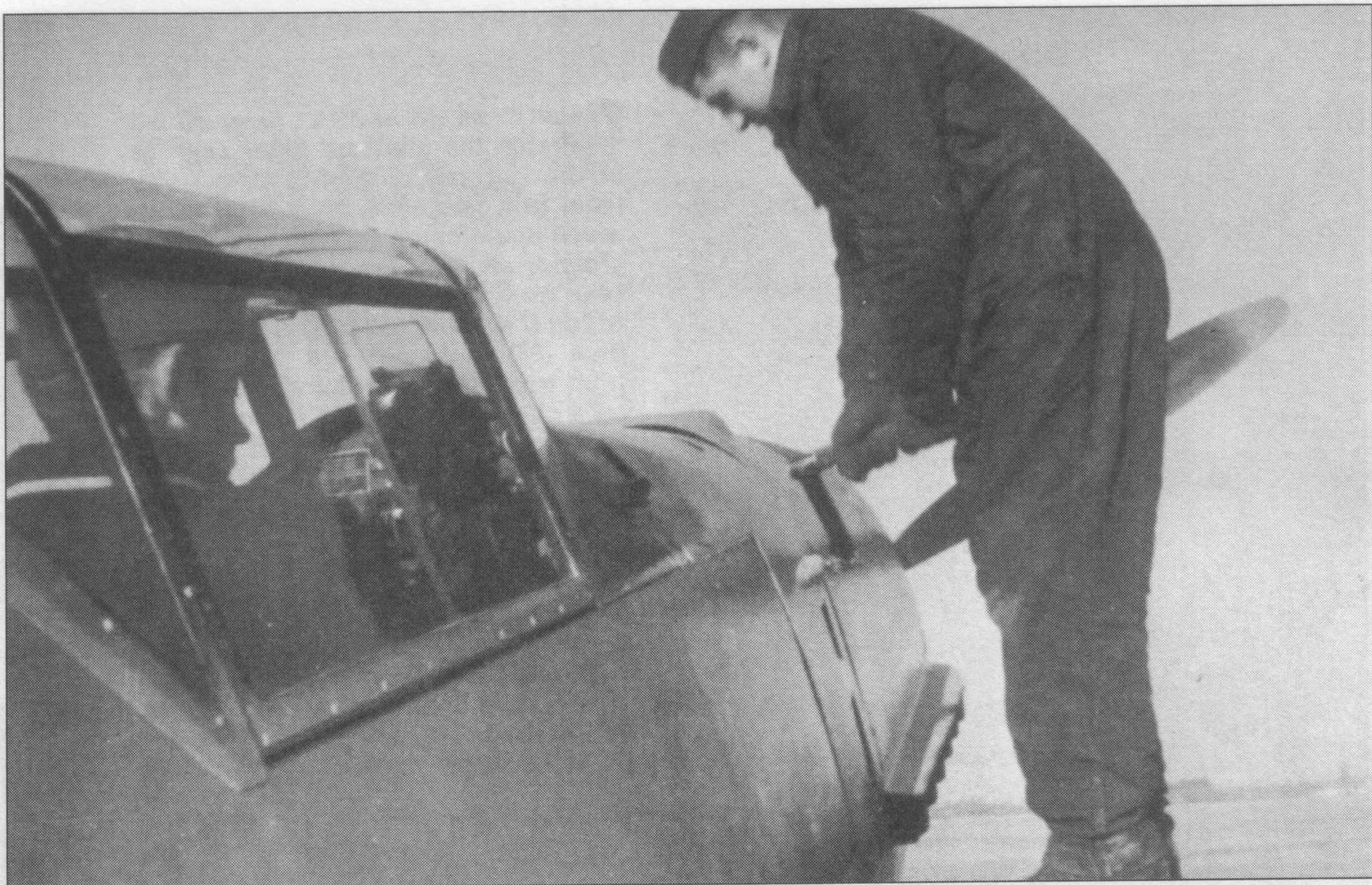
Немногие ранние E-1 оснащались ракетницей, строенной в правый борт фонаря.
