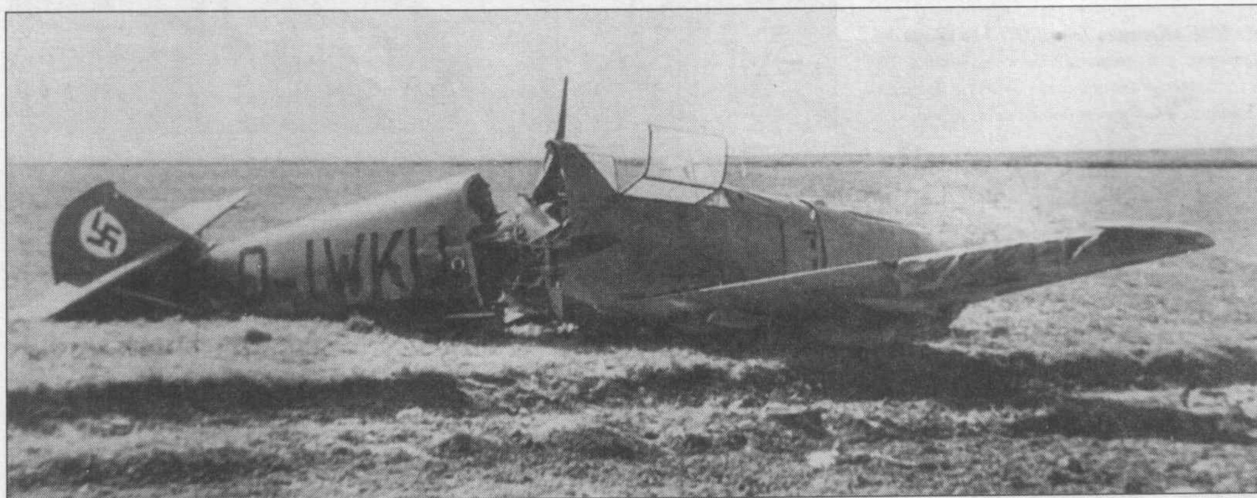
Серия из четырех снимков разбитого Me 109E с гражданским номером D-IWKU, нанесенным поверх номера L-55. У самолета нет вооружения в крыльях, но места для пушек MG FF предусмотрены. Обратите внимание на фюзеляж, разломившийся позади кабины. Это было одно из слабых мест «мессера».
