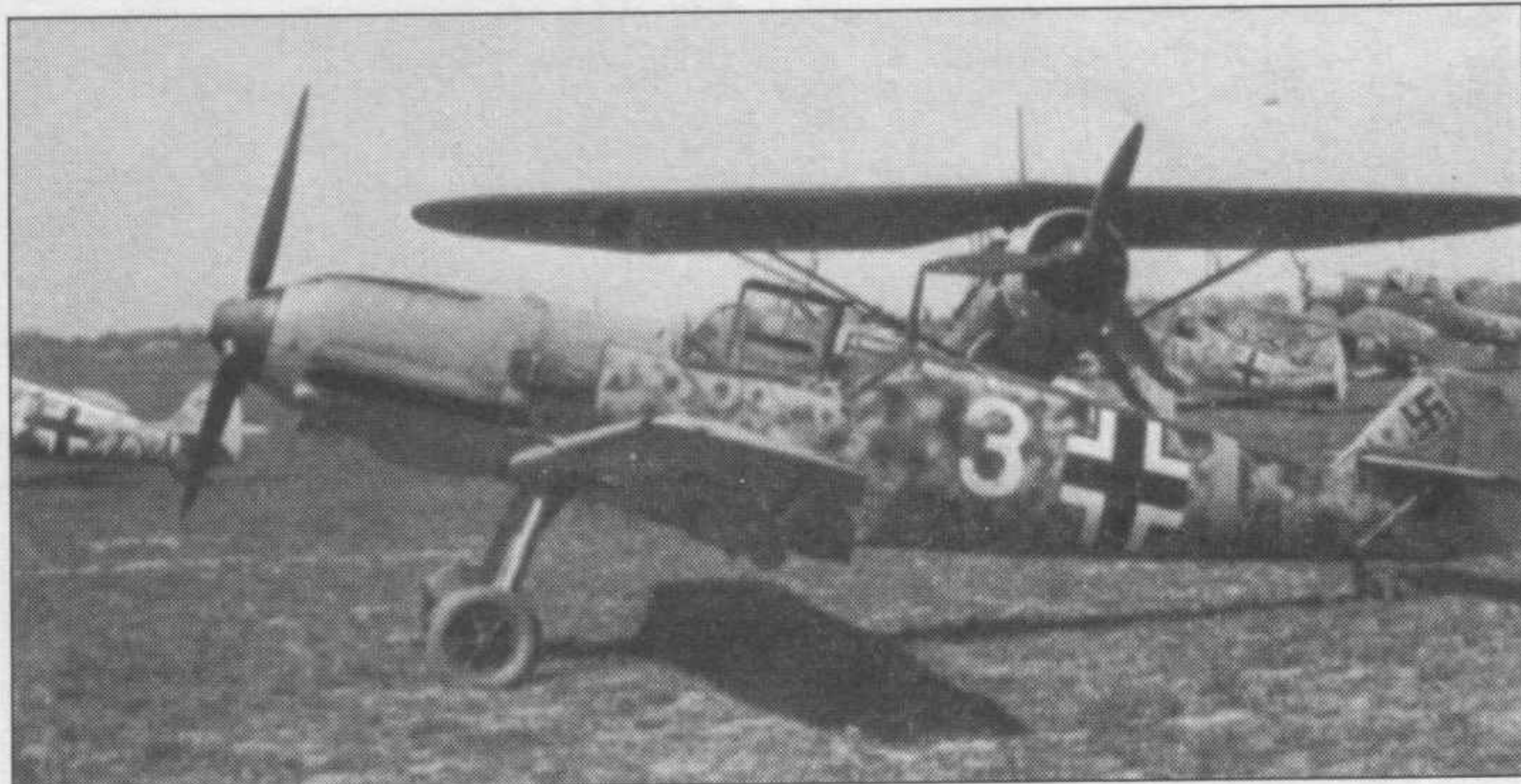
«Белая 3» из III./JG 54 - Me 109E-4 с бронированной кабиной, лето 1941 года, Восточный фронт. Обычным элементом быстрой идентификации на Восточном фронте выступали желтая полоса на фюзеляже или желтый руль направления. Позднее появились желтые законцовки крыльев. Желтый капот остался от прежних кампаний.
