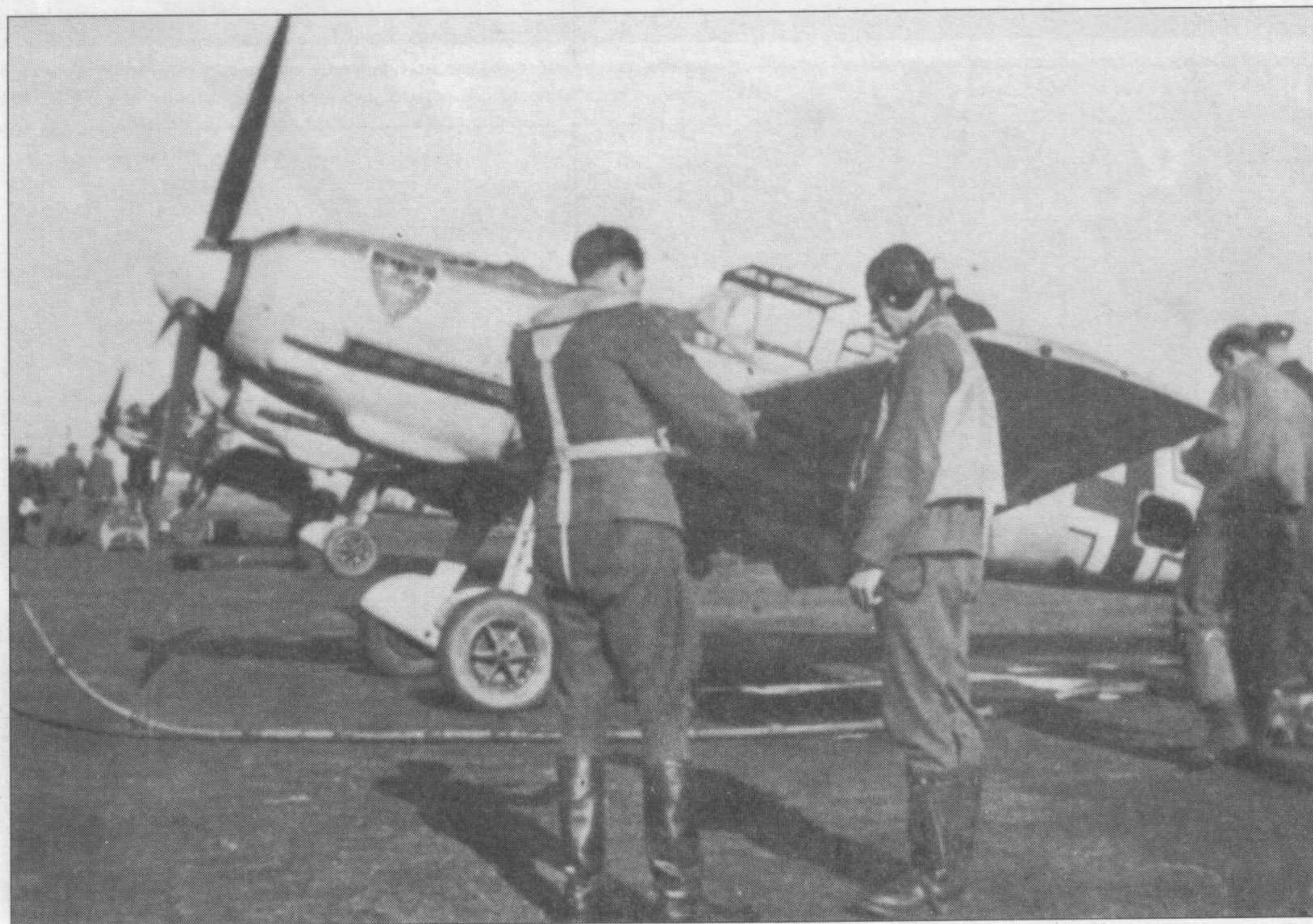
Me 109E-4 ранней серии из III./JG 54 Gruenherz, базировавшегося на берегу Ла-Манша. Кабина данного самолета не бронирована.
