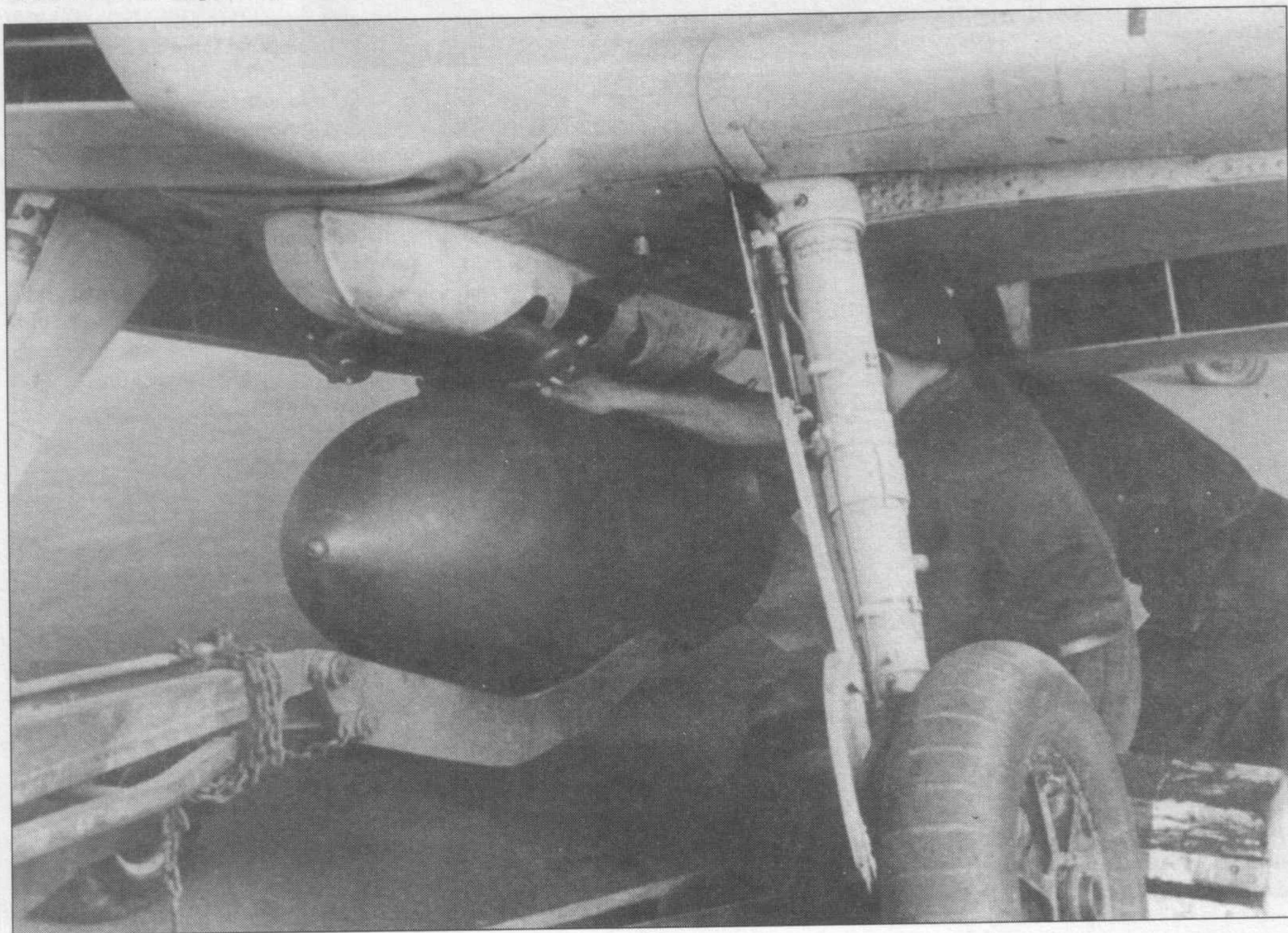
Два снимка, сделанных в ходе подвешивания 250-кг бомбы на пилон ETC 500. Me 109E мог брать в перегруз 500-кг бомбу, но эту возможность очень редко практиковали из-за слишком большой перегрузки машины.
