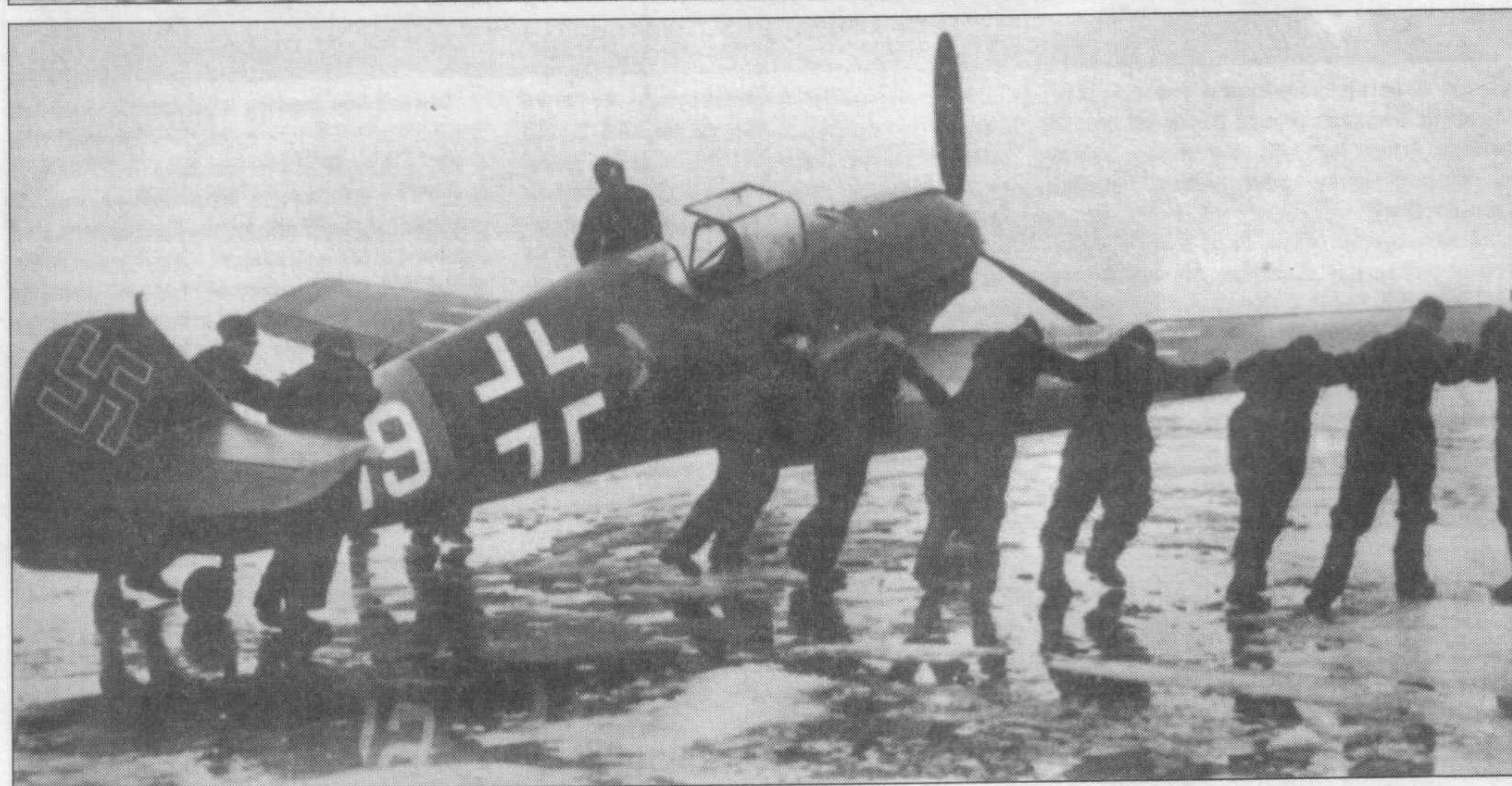
Два снимка Me 109E-0, выпущенного в начале 1938 года. Два самолета этого типа использовались для дезинформации противника. Обратите внимание на характерные черты машины: отсутствие в капоте каналов для пулеметов, отсутствие антенной мачты (несмотря на то, что на киле есть крепление для антенны), удлиненный воздухозаборник турбонаддува, а также выхлопные патрубки новой формы. Самолет на снимках несет трехцветный камуфляж (70/71/02) и опознавательные знаки, обычные для учебной части. Обратите внимание на эмблему, нанесенную рядом с крестом.
