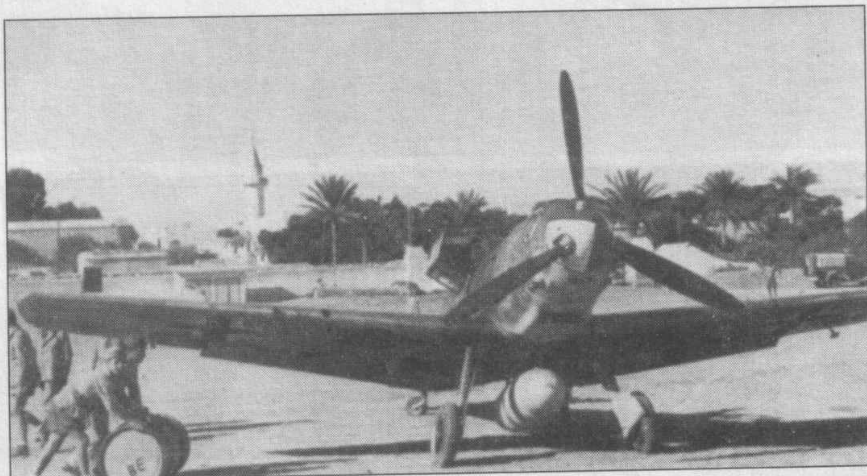
Me 109E-7 из 7./JG 26, Сицилия, весна 1941 года. В кабине оберфельдфебель Лаубе. Рядом с пушкой в крыле виден объектив фотопулемета BSK. Фотопулемет устанавливали на место, предназначенное для пулемета MG 17. О назначении фотопулеметов неизвестно.
