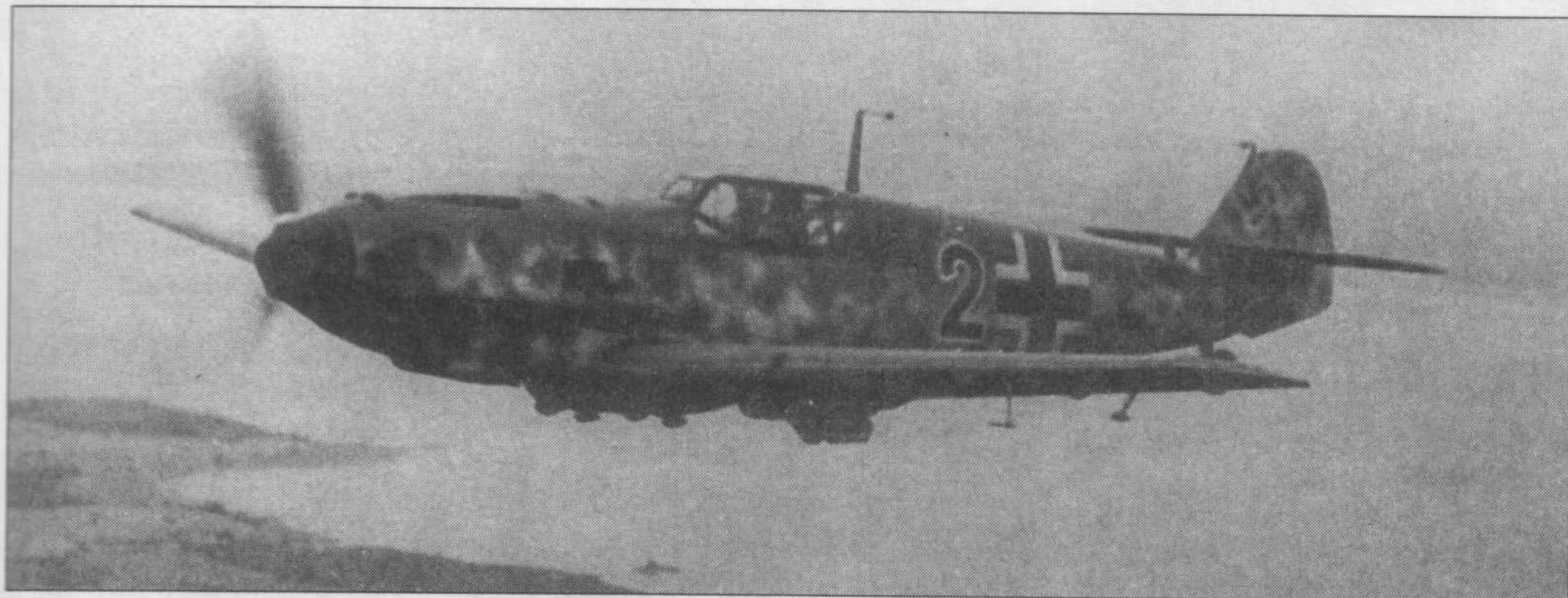
Me 109 E-1/V из неизвестной части, Западная Европа, конец 1940 года. Самолет довольно нетипичен, в первую очередь бросается в глаза камуфляж 74/75/76 и фонарь с усиленной рамой. Обратите внимание, что пятнистый камуфляж закрывает не только борта, но и часть голубого низа самолета.
