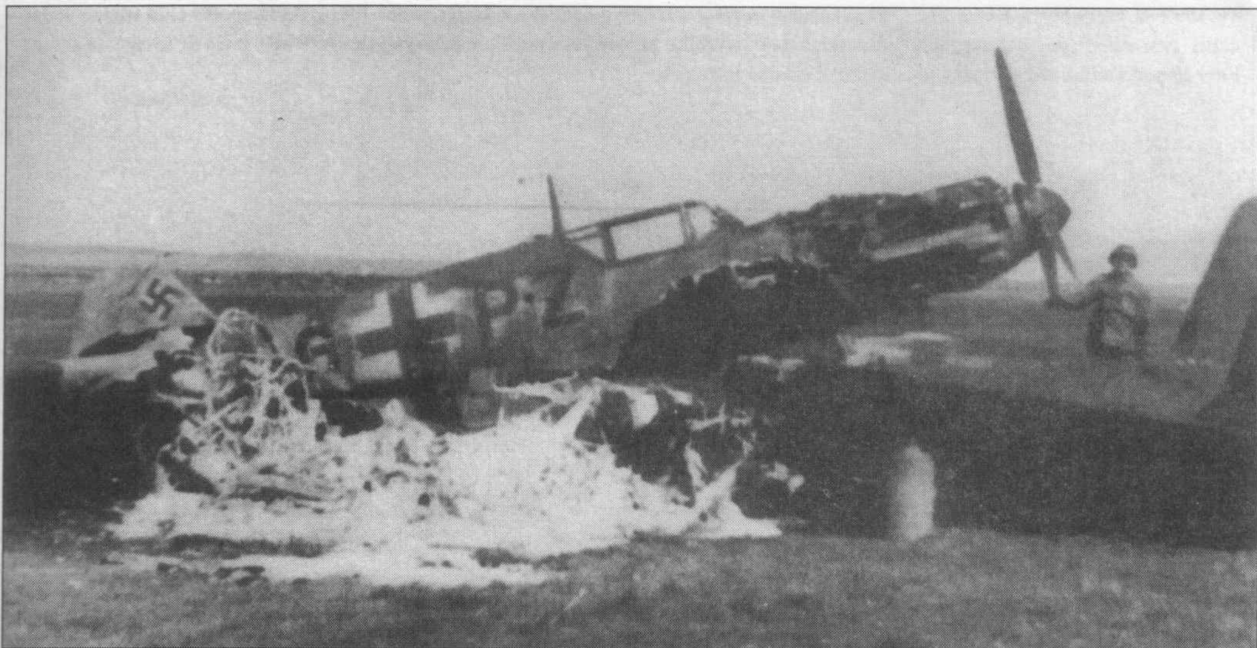
Me 109T, обнаруженный американцами в Гота в 1945 году. Бортовой код ?G+PZ, желтая полоса быстрой идентификации. Обратите внимание на воздухозаборник турбонаддува, его конструкция характерна для самолетов, выпущенных на фирме Fieseler в 1941 году.
