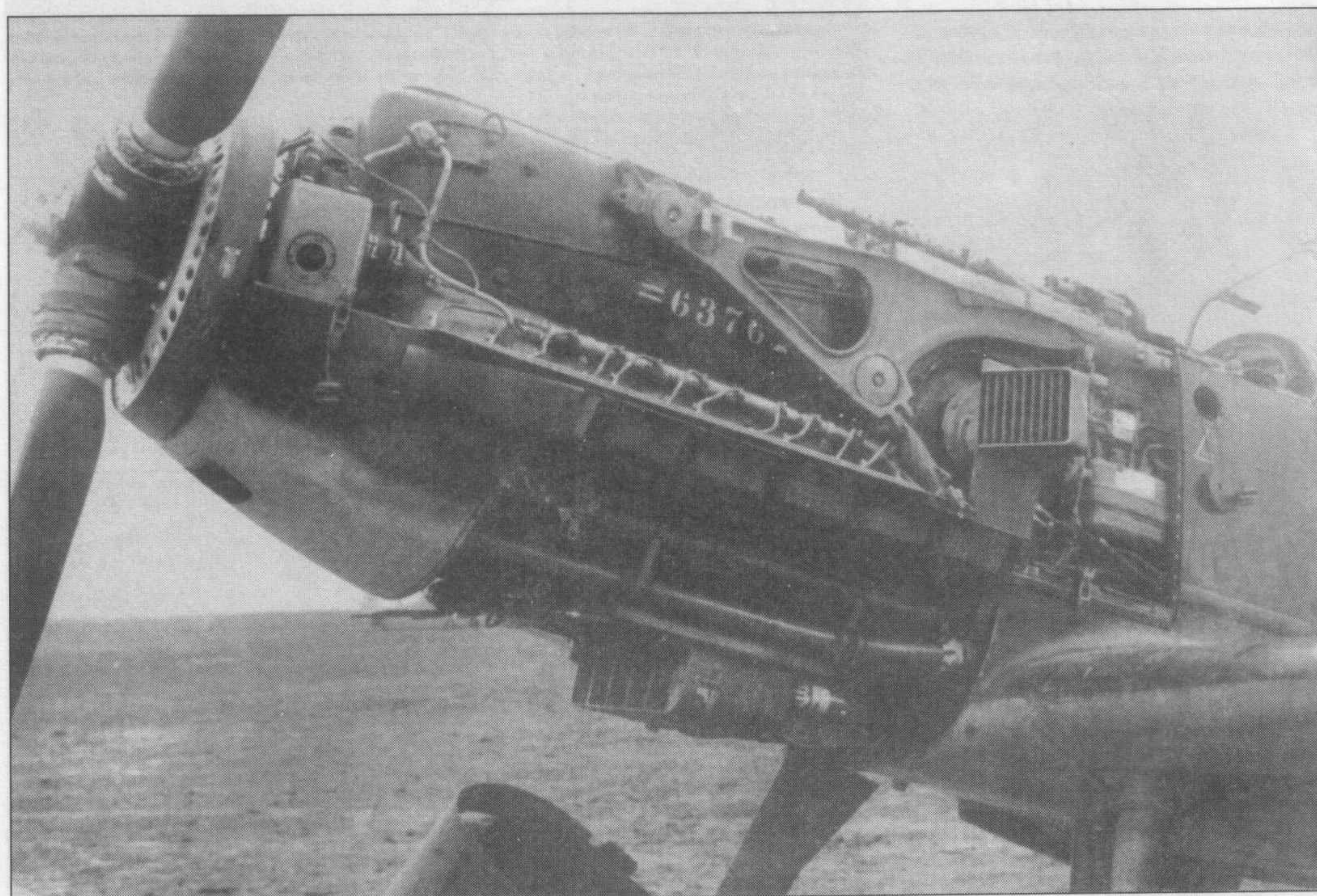
Двигатель DB 601A (W.Nr. 63762) на Me 109E, 1941 год. Видна моторная рама совершенно иной конструкции. На Me 109F и G рама была еще более усилена.
