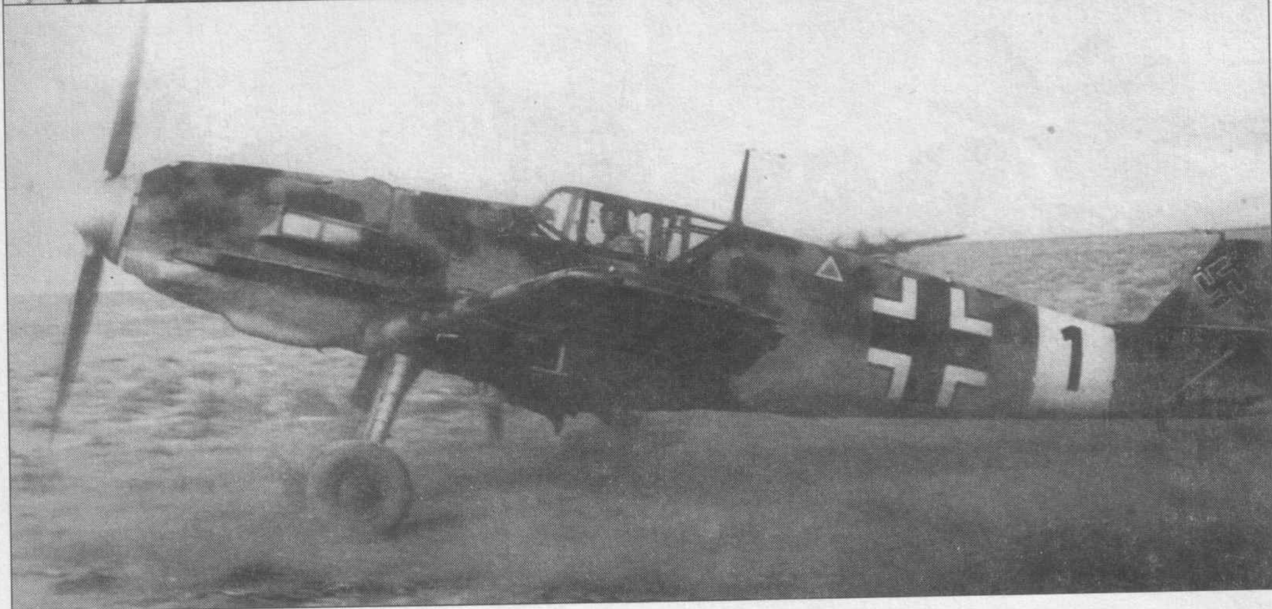
Me 109E-9/trop из разведывательной эскадрильи 2.(H)/14, осень 1941 года. Первоначально «Эмиль-9» рассматривался как вариант E-7, поэтому шел в документах как E-7 или E-7/U. Самолеты оборудовались фотокамерами, установленными за третьим шпангоутом фюзеляжа. Отверстие для фотокамеры находится прямо под горловиной топливного бака.
