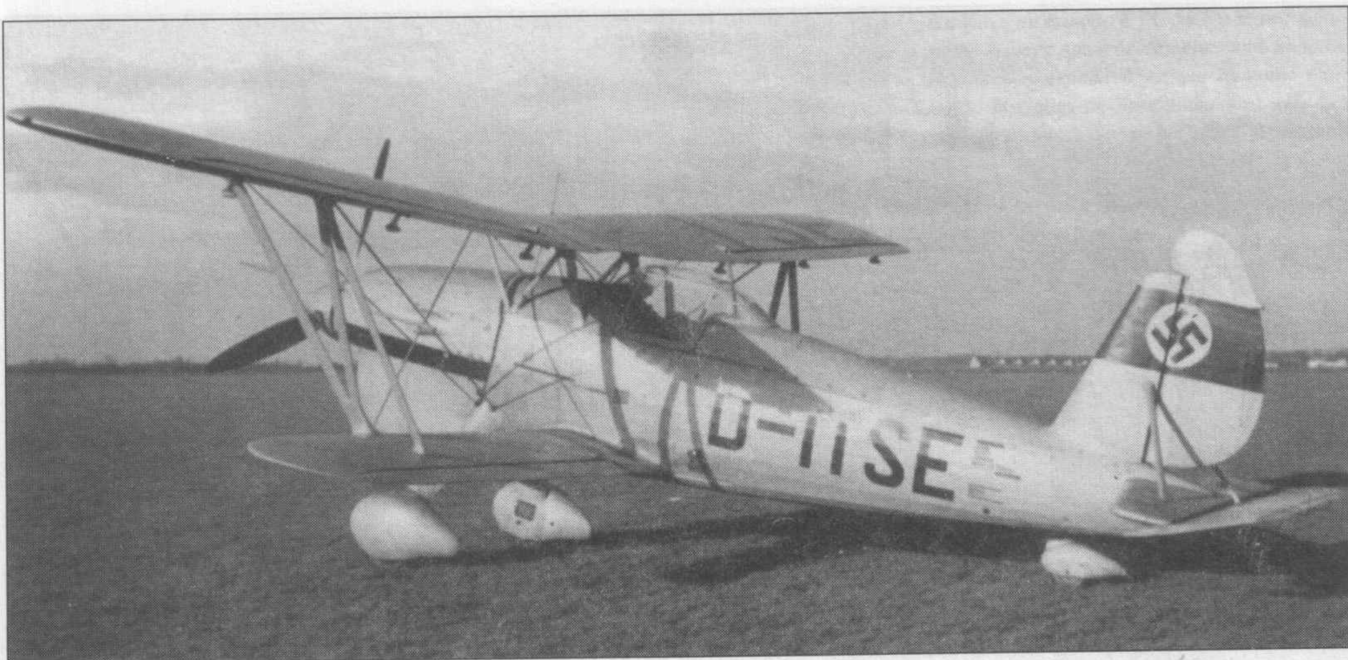
Палубный истребитель кригсмарине Ar 197. Удивительно, но этот допотопный биплан был разработан в 1936 году. Первые полеты прототип совершил в начале 1937 года. Несмотря на неплохие характеристики (максимальная скорость более 400 км/ч) самолет был обречен с самого начала.
