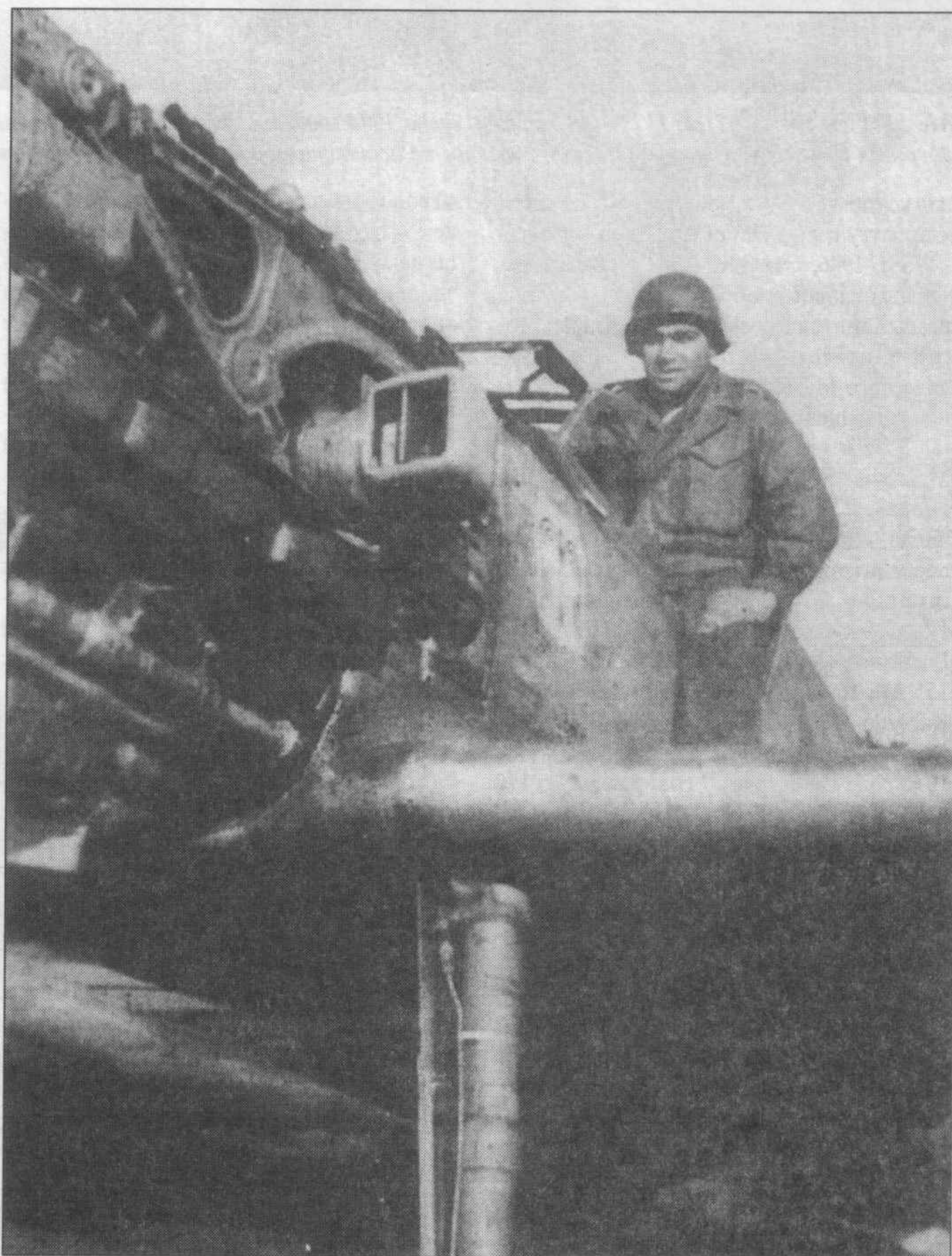
Me 109T, обнаруженный американцами в Гота в 1945 году. Бортовой код ?G+PZ, желтая полоса быстрой идентификации. Обратите внимание на воздухозаборник турбонаддува, его конструкция характерна для самолетов, выпущенных на фирме Fieseler в 1941 году.
