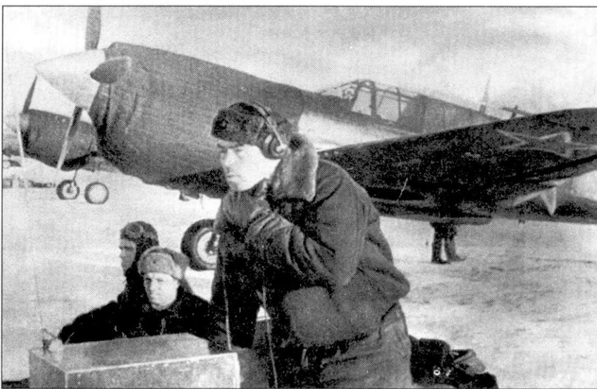
Североморский Р-40 на аэродроме, зима 1943/44 г.г. Виден специальный «кожух», защищающий мотор от переохлаждения.
