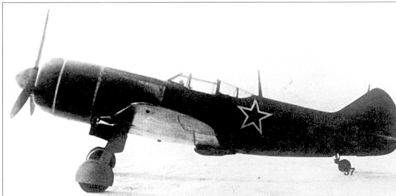
Ла-7 раннего выпуска можно отличить по антенне, аналогичной Ла-5ФН.
