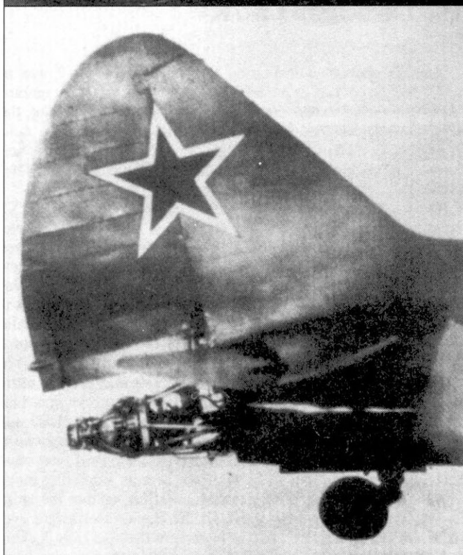
Хвостовая часть фюзеляжа Ла-7Р с сопловой аппаратурой ЖРД РД-1.
