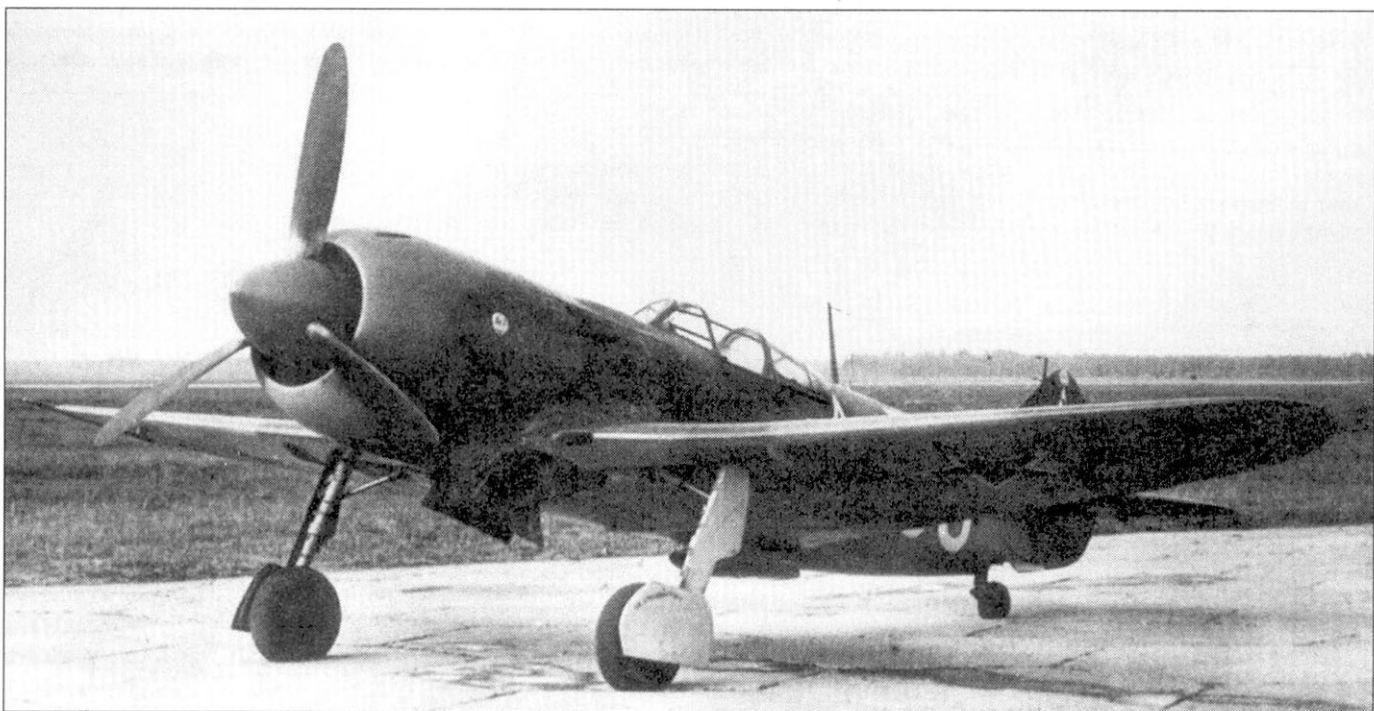
Истребитель Ла-7 первой серии, заводской номер 452101150. В качестве бортового номера используются последние две цифры заводского номера - «50». Камуфляж самолета состоит из серых и зеленых пятен, низ - светло-голубой. Этот самолет проходил сравнительные испытания с прототипом в НИИ ВВС.
