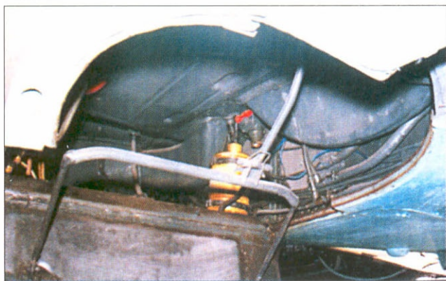
Колодцы колес шасси полностью закрываются, помимо колес в них находится арматура ряда систем самолета, в частности воздуховод от воздухозаборника к нагнетателю.
