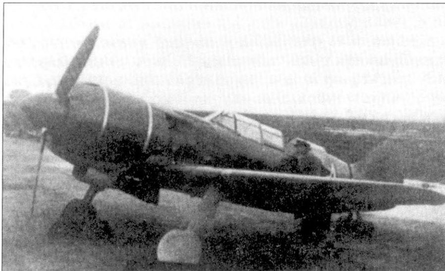
Перенос на серийных Ла-7УТИ под капот двигателя маслорадиатора позволил привести в норму управляемость, но одновременно несколько ухудшил аэродинамику.
