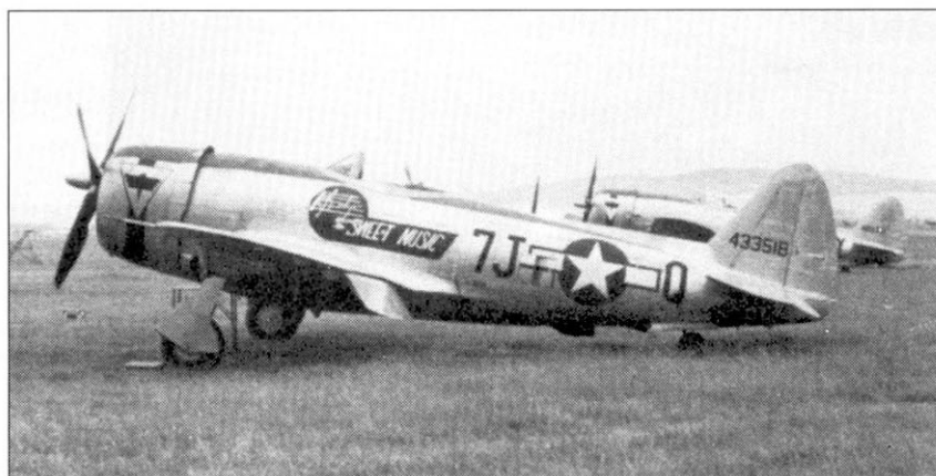
«Sweet Music» - истребитель P-47D-30 из 508-й эскадрильи 404-й истребительной авиагруппы, аэродром Фрицлер, Германия, лето 1945 г. Самолет имеет форкиль, в заводских условиях форкили стали устанавливать на «Тандерболтах», начиная с модификации D-40.
