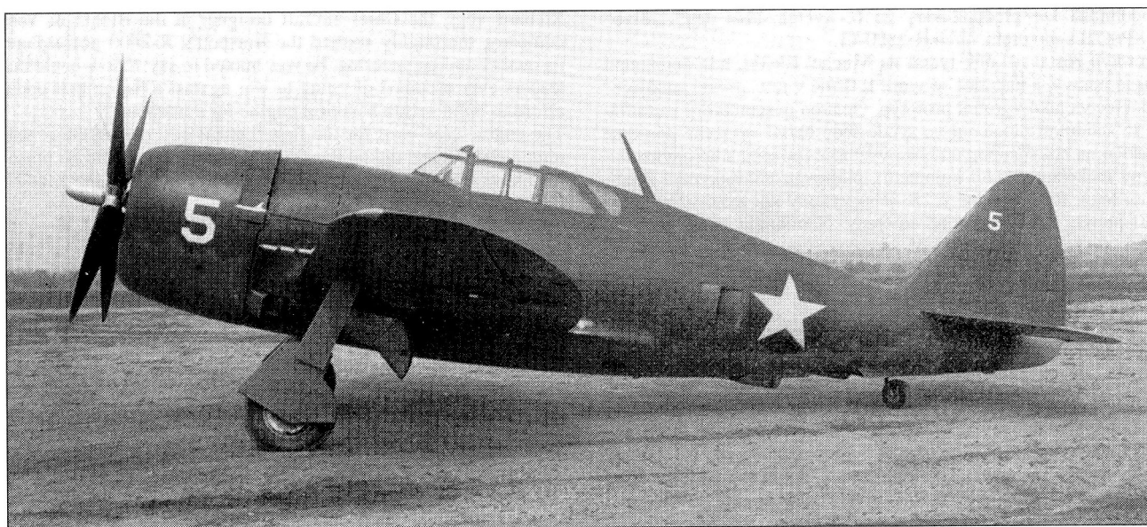
Один из первых серийных истребителей P-47B Обратите внимание на остекление фонаря кабины, выполненное по типу остекления фонаря кабины опытного (Y)P-47B.
