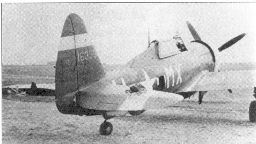
Боевые повреждения истребителя Р-47С из 78-й истребительной авиагруппы. Одним из достоинств «Тандерболта» являлась его удивительная живучесть.
