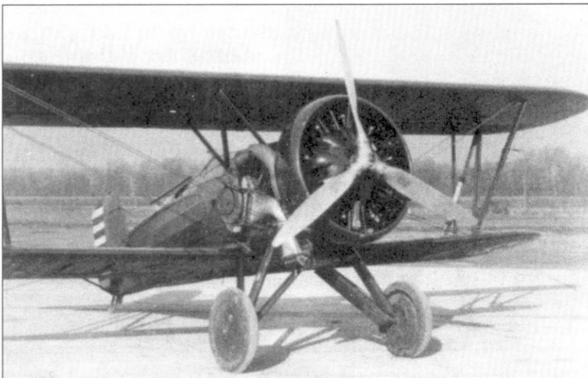
Одним из первых высотных истребителей стал оборудованный турбокомпрессором самолет Боинг P-12G, турбокомпрессор установлен в борту передней части фюзеляжа.
