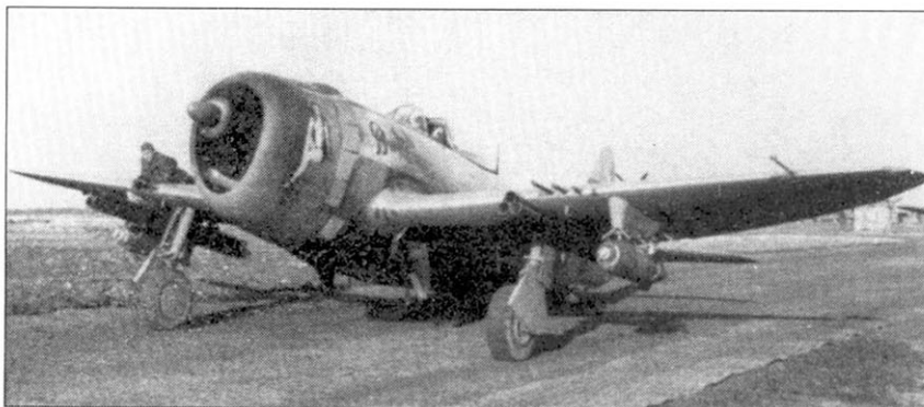
«Butch» - истребитель из 50-й истребительной группы. Р-47Д вырывается по металлической дорожке на старт, передовой аэродром во Франции, весна 1945 г. Обратите внимание на внешнюю подвеску - 5-дюймовые неуправляемые ракеты и 500-фунтовые авиабомбы. На правой плоскости крыла пристроился механик, который помогает летчику выдерживать направление движения на рулежке.
