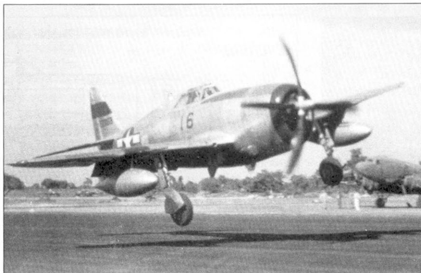
Крайне опасная посадка «Тандерболта» с подвешенными под крылом дополнительными топливными баками. Снимок истребителя P-47D-23-RA (заводской номер 42-28153) сделан 11 августа 1944 г. на аэродроме в Восточной Индии. Неокрашенная машина принадлежала командиру 1-й авиагруппы коммандос.
