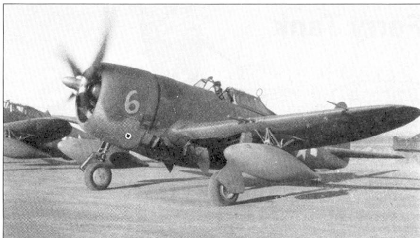
Истребитель P-47D ранней производственной серии сфотографирован на аэродроме Микс-Филд в Исландии. Здесь «Тандерболты» заправлялись горючим при перелете через Северную Атлантику из США в Великобританию. Истребитель P-47D-1 можно отличить от P-47C по дополнительным отклоняемым поверхностям «юбки» капота двигателя. Обратите внимание на дополнительные подкрыльевые топливные баки фирмы Локхид.
