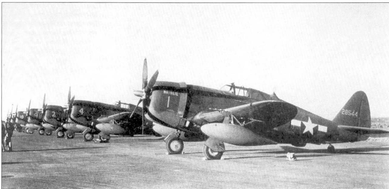
Истребители P-47D-5-RE выпускались без подкрыльевых пилонов. На этих самолетах, подготовленных к перелету из США в Британию под крыльями фиксированно смонтированы 620-литровые дополнительные топливные баки от истребителя P-38 «Лайтнинг». На переднем плане - самолет с собственным именем «Natalie», машина оснащена радиоконпасом - обратите внимание на рамочную антенну на фюзеляже за кабиной летчика.
