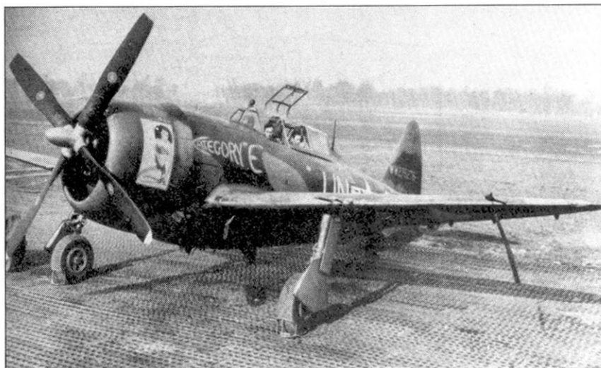
Хотя лишь два «Тандерболта» в двухместном исполнении изготовили непосредственно на заводе, множество «DubleBolts» было переоборудовано из одноместных силами ремонтных мастерских. На снимке - один из таких самолетов, P-47D-11 с собственным именем «Category E» из 63-й эскадрильи 56-й истребительной авиагруппы. Самолет ранее успел повоевать в качестве одноместного.
