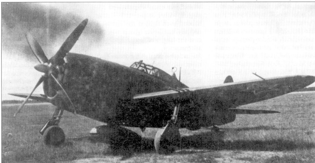
Один из первых «Тандерболтов», попавших в СССР. Обратите внимание на вооружение истребителя - шесть пулеметов, судя по рамочной антенне за кабиной летчика на самолете установлен радиокompас.
