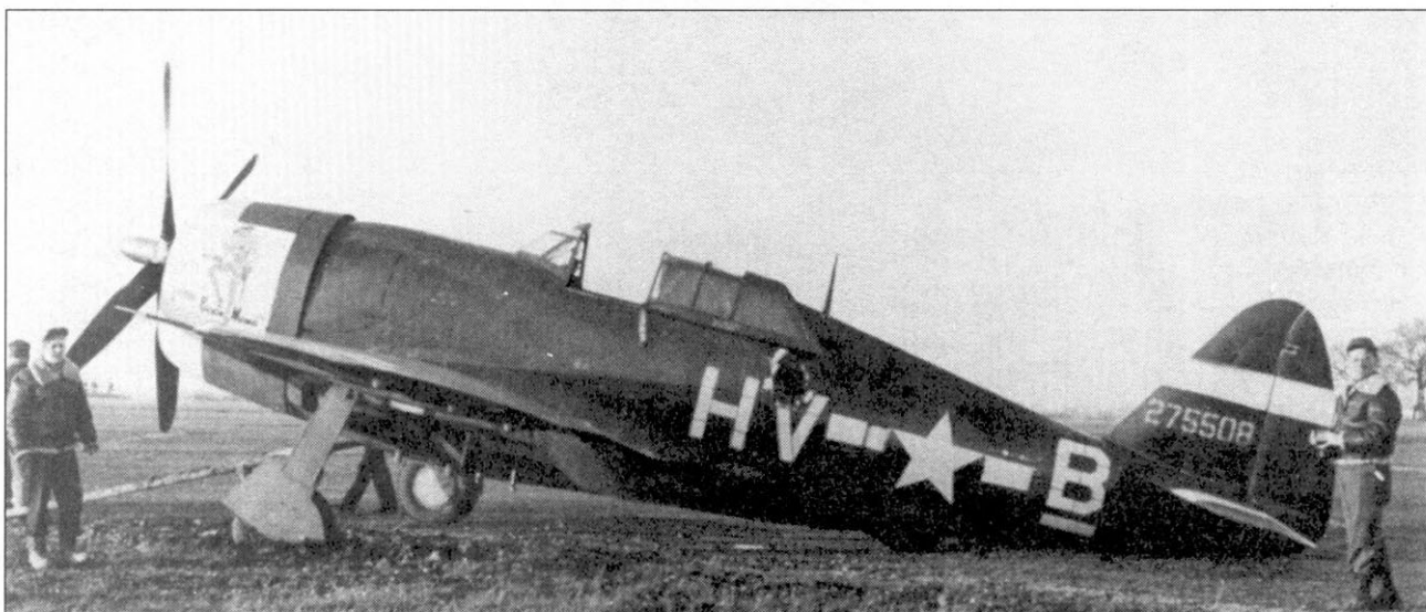
На самолете «Pistol Packin' Mama» в 1944 г. летал пилот 56-й истребительной авиагруппы Прагер Ньолэнд. Снимок сделан после воздушного боя с истребителем Fw-190. «Тандерболт» получил несколько попаданий 20-м снарядами (обратите внимание на дыру в борту фюзеляжа), в частности была перебита стойка хвостового колеса, в результате при посадке самолет получил незначительные повреждения хвостового оперения. Обратите внимание на подчеркнутую букву «B», в 61-й эскадрильи два самолета имели идентификационную литеру «B», чтобы их отличить на истребителе Ньюмэна литеру подчеркнули.
