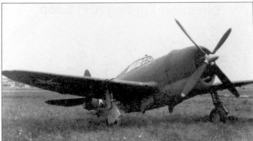
Истребители P-47G имели различную форму гаргрота, на снимке - самолет производства фирмы Кертис Эйркрафт Корпорейшн. Два самолета P-47G-15 были построены в двухместном варианте - единственные двухместные «Тандерболты» заводского изготовления.
