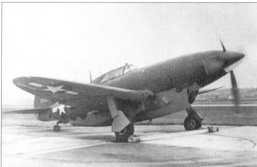
XP-47H - модификация планера стандартного P-47D-15 под установку 16-цилиндрового двигателя жидкостного охлаждения Крайслер XI-2220 мощностью 2500 л.с. Несмотря на меньший мидель двигателя и большую мощность по сравнению со штатным звездообразным мотором, XP-47H не смог превзойти значения скорости в 414 миль/ч, а первый полет выполнил только в июле 1945 г.
