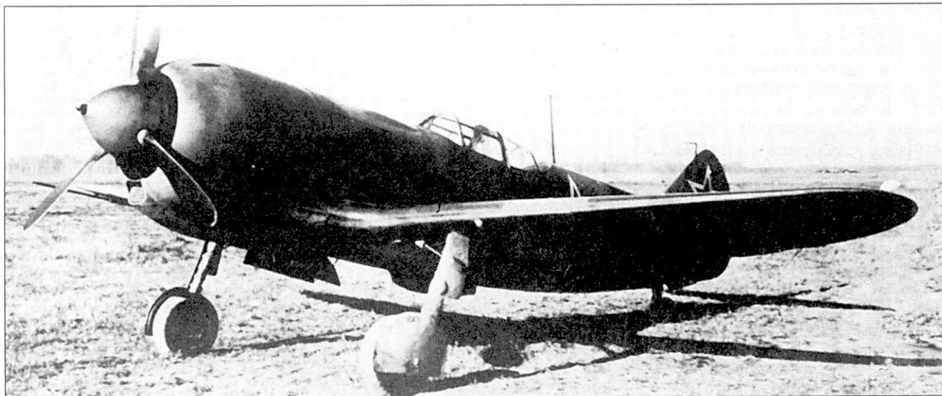
В конструкцию истребителя Ла-5ФН модель 1944 г. были частично внедрены аэродинамические улучшения, апробированные на Ла-5 «206».
