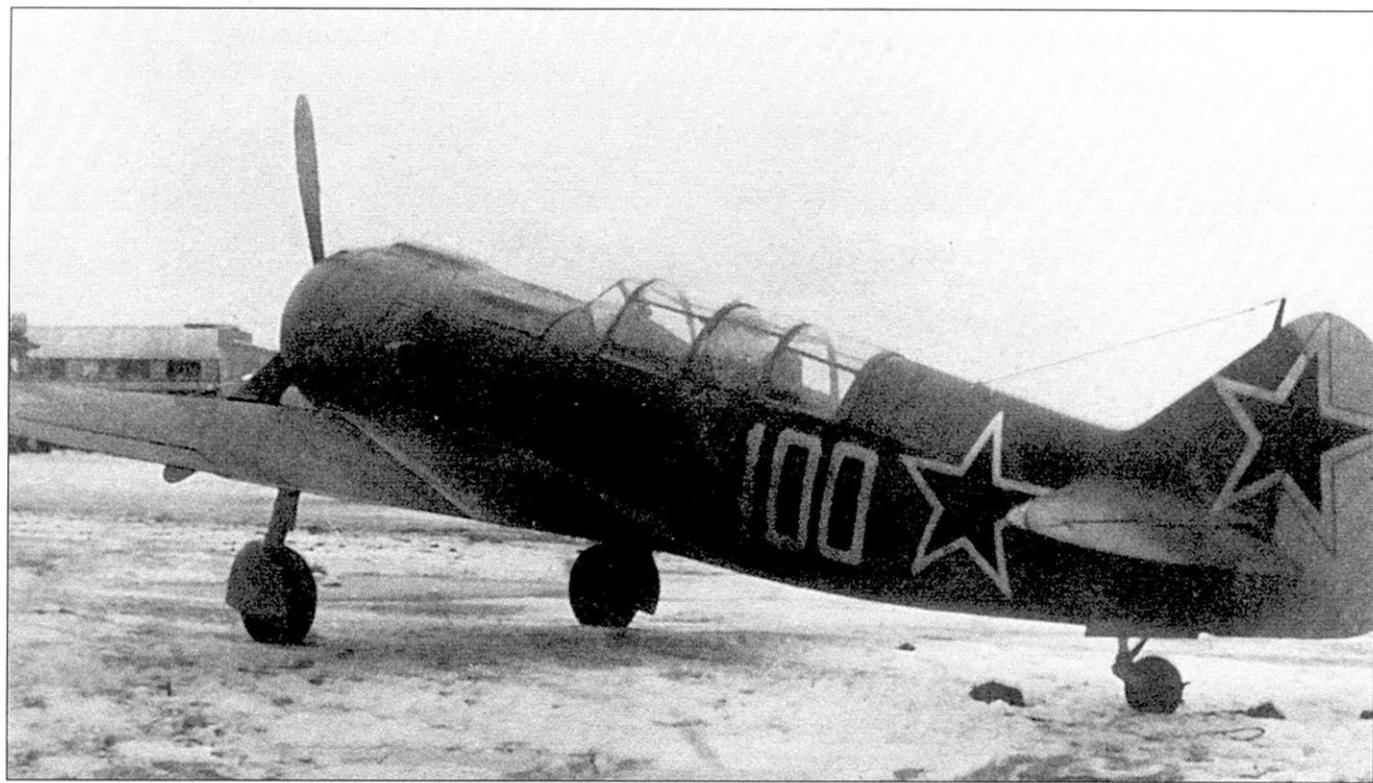
Ла-5УТИ с бортовым номером «100» белого цвета был конвертирован в двухместный из боевого истребителя в ремонтной мастерской. Высокий гаргрот указывает на то, что «исходным материалом» для переделки послужил оснащенный мотором АШ-82А истребитель Ла-5 с кабиной по типу кабины ЛаГГ-3. Самолет оснащен радиостанцией.
