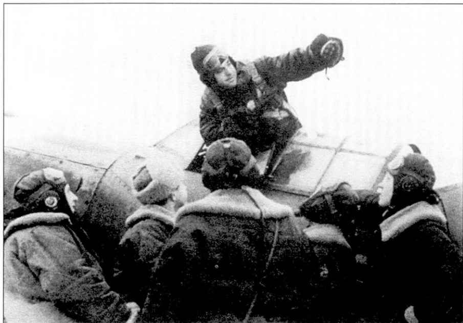
Редкий кадр - на снимке Ла-5ФН, сдвижная часть фонаря которого имеет дополнительный вертикальный переплет. Насколько известно всего несколько самолетов марки Ла имели такие фонари, изготовленные в ремонтных мастерских.
