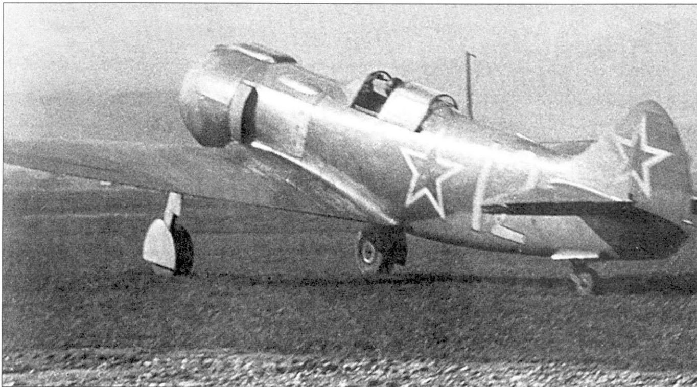
Ла-5ФН с бортовым номером «12» из 1-го чехословацкого ИАП сфотографирован на аэродроме Три Дуба. На момент эвакуации аэродрома этот самолет находился в непригодном к полетам состоянии, его пришлось уничтожить, чтобы не оставлять немцам. На рулежке и взлете летчики оставляли фонарь кабины открытым, чтобы можно было быстро покинуть самолет при возникновении аварийной ситуации.
