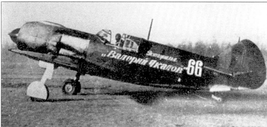
Истребитель Ла-5 вырывается с старта, Курская дуга, лето 1943 г., аэродром расположен севернее Белгорода. В этом секторе противниками пилотов Ла-5 были летчики 4-го воздушного флота люфтваффе. На снимке хорошо заметна жаропрочная накладная панель цвета натурального металла, кок винта - белый, законцовка вертикального оперения - желтая.
