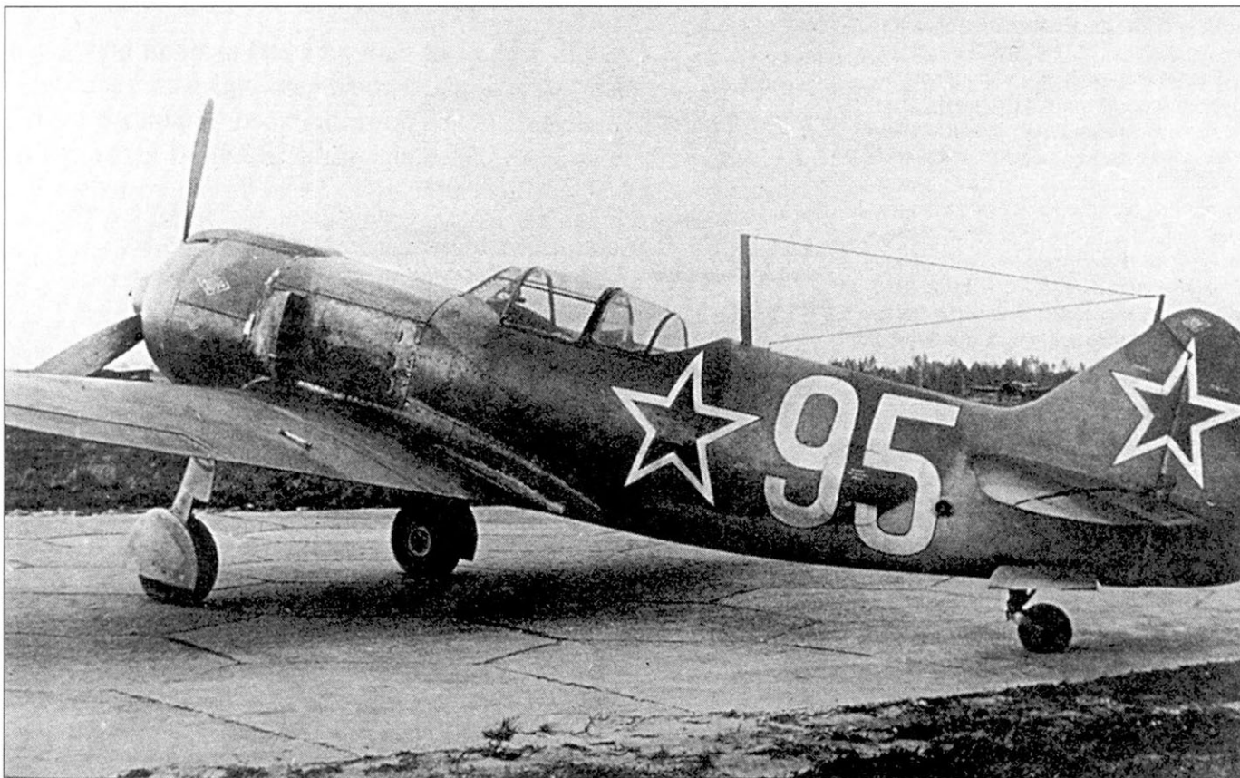
Ла-5ФН (бортовой номер «95» белого цвета) на аэродроме ЛИИ. Обратите внимание на вписанные в ромб логотип «ФН», такой же знак имеется на верхушке киля. Примечательна мачта радиоантенны, характерная для самолетов вариантов «ФН» ранних выпусков. Вместо единого выхлопного коллектора, на Ла-5ФН был сделан вывод выхлопных патрубков двигателя через щель с подвижной крышкой. Обратите внимание на необычное написание цифр номера: «5» по высоте больше, чем «9».
