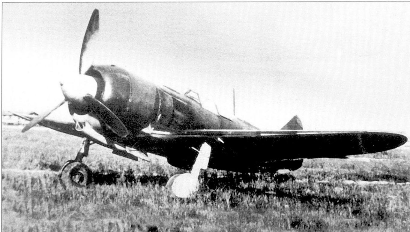
На истребителе Ла-5/АШ-71Ф попытались добиться улучшения летных данных за счет интеграции в конструкцию самолета Ла-5ФН 18-цилиндрового двигателя АШ-71Ф мощностью 2000 л.с. Из-за ненадежной работы мотора работы по созданию Ла-5/АШ-71Ф пришлось остановить.
