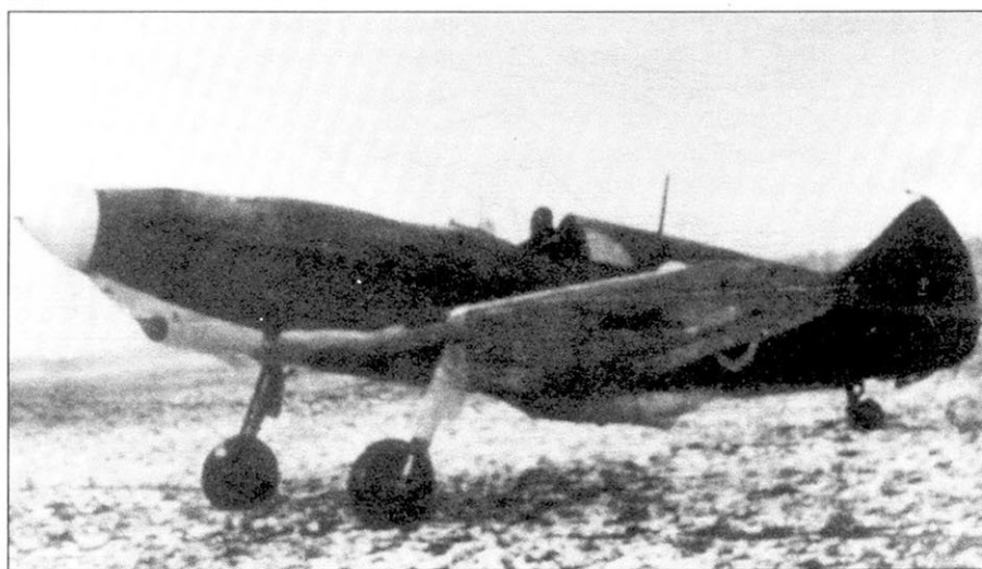
Истребитель ЛаГГ-3, оснащенный двигателем Климова М-105 мощностью 1100 л.с., уступал по характеристикам немецким мессершмиттам и не пользовался популярностью у советских летчиков. Улучшить летные данные самолета можно было только за счет установки более мощного мотора.
