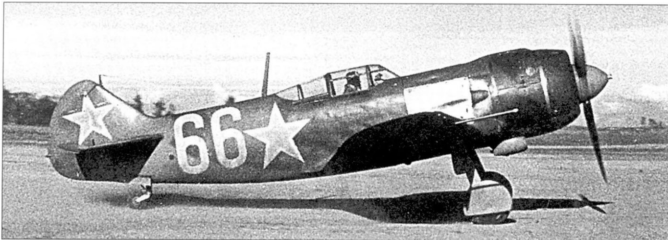
На снимке - Ла-5Ф («66» белого цвета) из 21-го истребительного авиационного полка, лето 1944 г. Бросается в глаза металлический блеск стяжных лент капота и жаропрочной накладки на борту фюзеляжа. На большинстве Ла-5Ф радиомачта устанавливалась с небольшим наклоном вперед. Новый фонарь и срезанный гаргрот резко улучшили обзор летчику.
