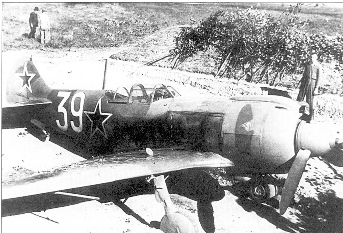
Подготовленный к вылету Ла-5ФН (бортовой номер «39» белого цвета) на стоянке, Польша. Заливочная горловина крыльевого топливного бака на правой плоскости открыта. Обратите внимание на уложенные в ряд срубленные молодые деревца - маскировка снята. Самолет оснащен бомбодержателями ДЗ-40.
