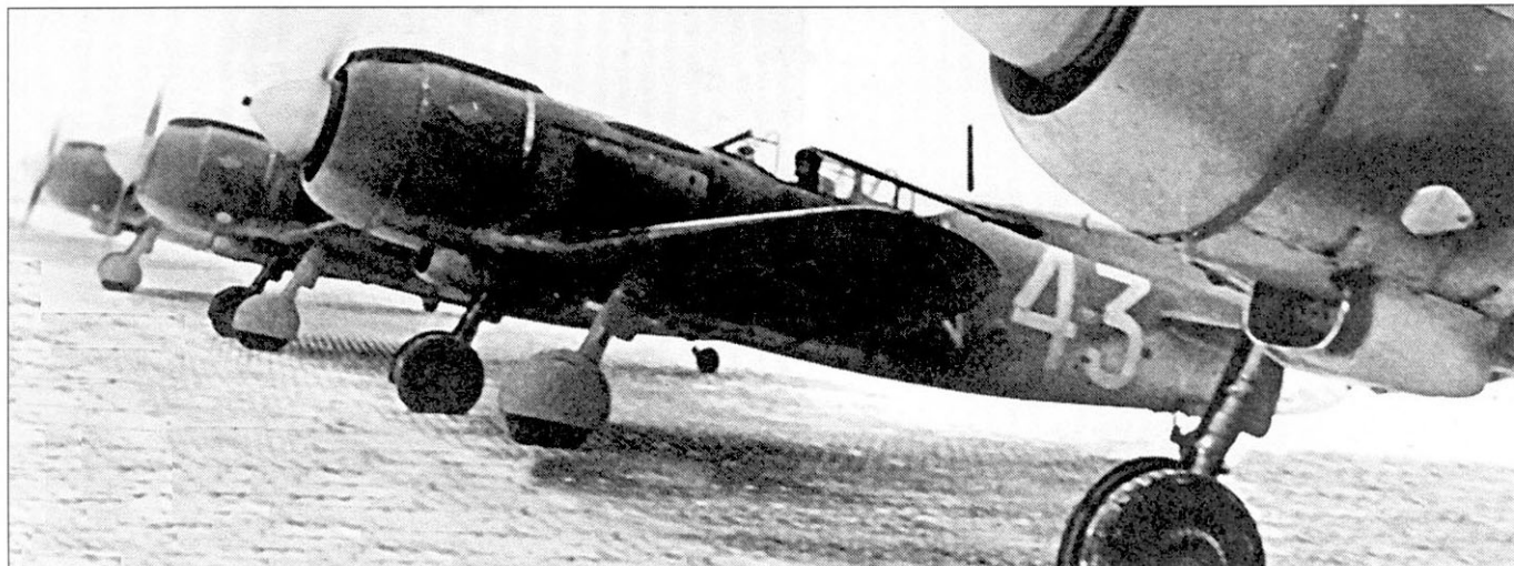
Истребители Ла-5ФН поздних выпусков имели дополнительный смотровой лючок в нижней части капота двигателя. Все запечатленные на снимке самолеты имеют рули направления желтого цвета.
