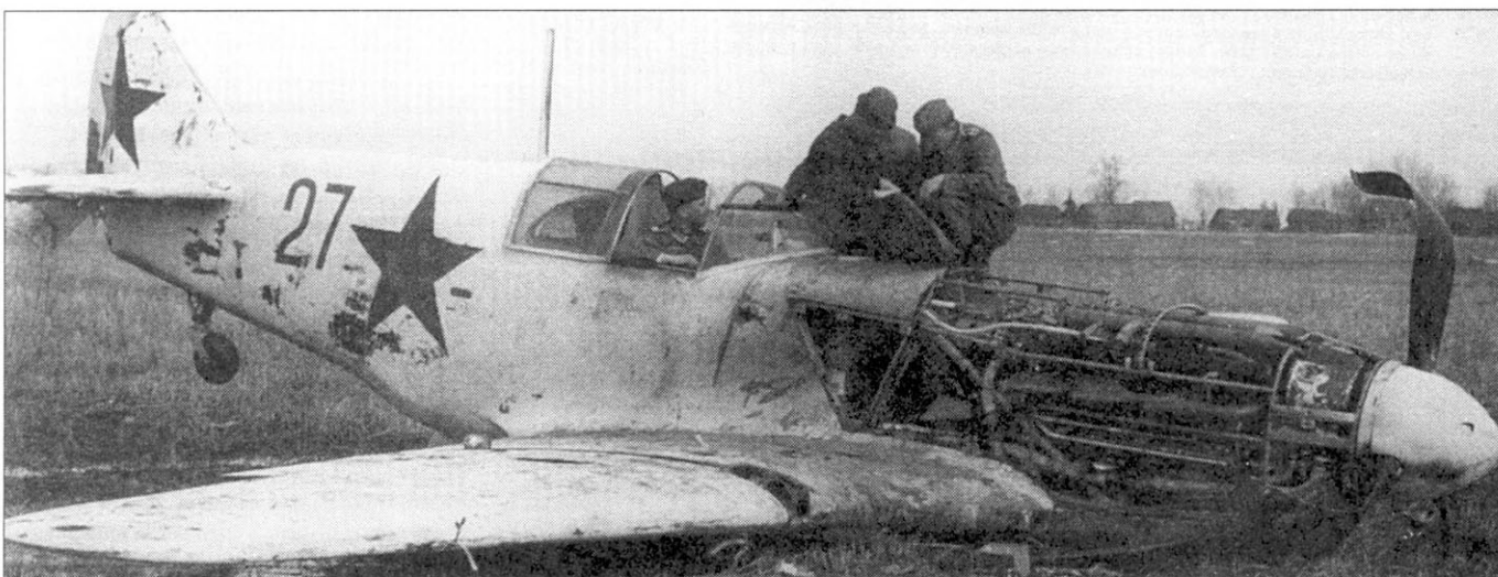
Немецкие солдаты осматривают севший на вынужденную посадку истребитель ЛаГГ-3 29 серии (бортовой номер «27» красного цвета) в зимней окраске. Самолет оснащен винтом изменяемого шага ВИШ-105СВ, который можно идентифицировать по коку увеличенного размера, такие нестандартные коки ставились только на машинах 29-й серии.
