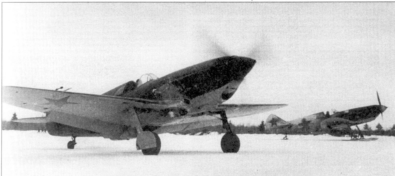
ЛаГГ-3 8-й серии из 5-го гвардейского истребительного полка перед взлетом с передового аэродрома, зима 1942 г.. На обоих самолетах демонтированы сдвижные сегменты фонарей кабин. Истребитель на переднем плане сохранил летнюю камуфляжную окраску. На заднем плане - ЛаГГ-3, окрашенный белый цвет, колеса шасси заменены лыжами, под крылом подвешены неуправляемые реактивные снаряды РС-82.
