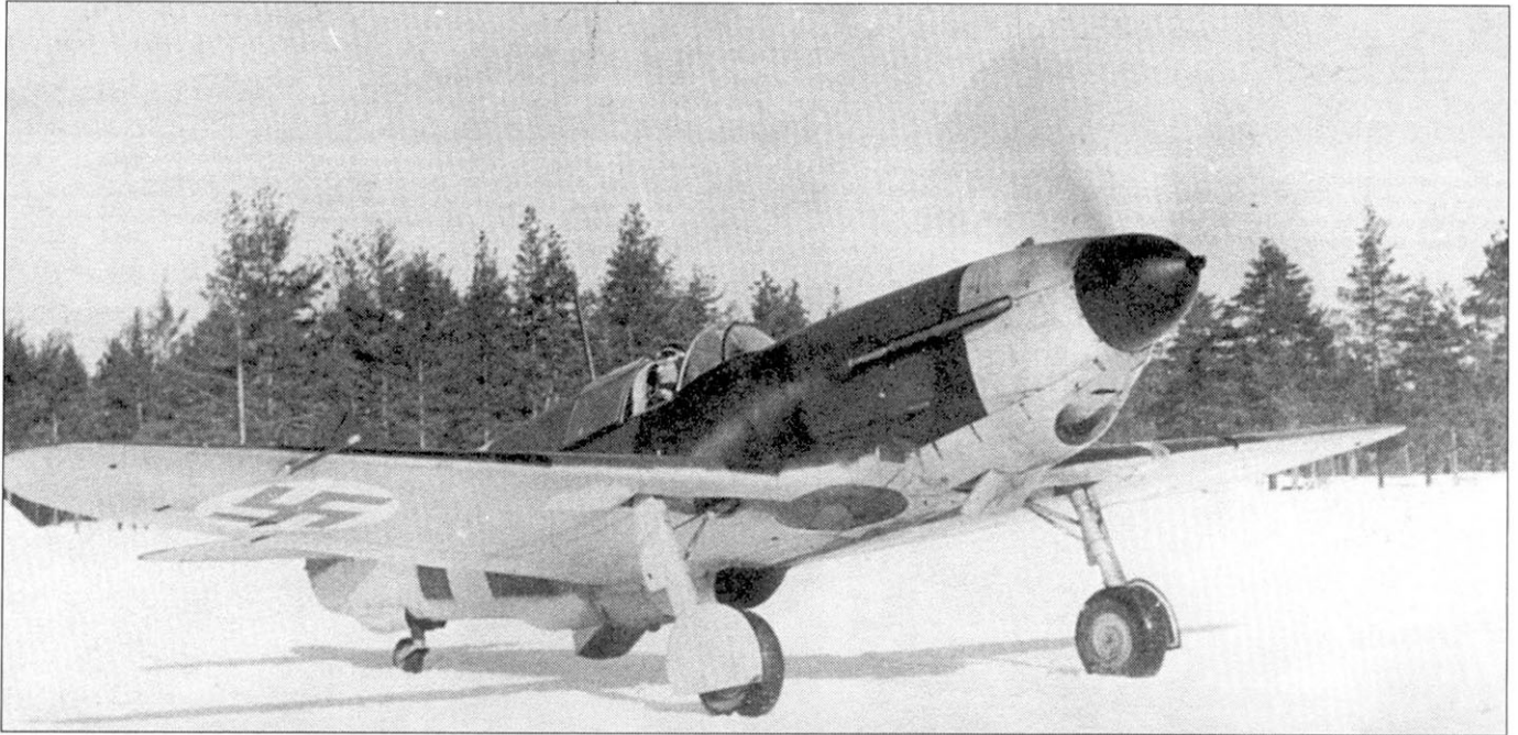
В кабине финского ЛаГГ-3 «LG-3» (истребитель 35-й производственной серии) командир LeLv-32 майор Аулис Бремер. На всех самолетах ЛаГГ-3, оснащенных предкрылками, крепление трубки Пито пришлось перенести на нижнюю поверхность плоскости крыла.
