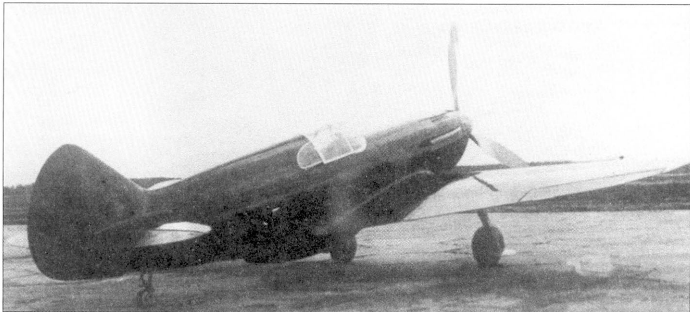
На втором прототипе не устанавливалась радиостанция, не было балансирующего груза на руле направления. Серийные ЛаГГ-3 оснащались радиостанциями, а руль имел весовую компенсацию. Вооружение второго прототипа истребителя И-301 состояло из трех пулеметов Березина УБС-12,7 калибра 12,7 мм.
