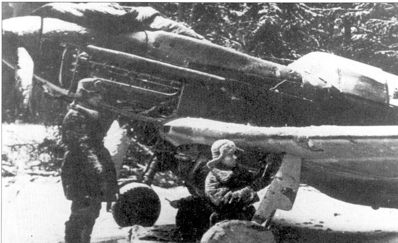
Наземный персонал ремонтирует ЛаГГ-3 4-й серии в условиях суровой русской зимы, Калининский фронт, начало 1942 г. Обратите внимание на воздухозаборник прямоугольной формы в корневой части крыла, такие воздухозаборники были введены на самолетах 4-й производственной серии.
