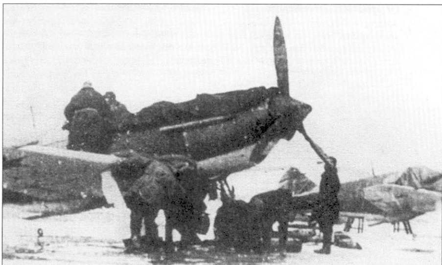
Линейка истребителей ЛаГГ-3 11-й серии, все самолеты оснащены лыжами и окрашены в белый цвет. Белая краска сильно облезла.
