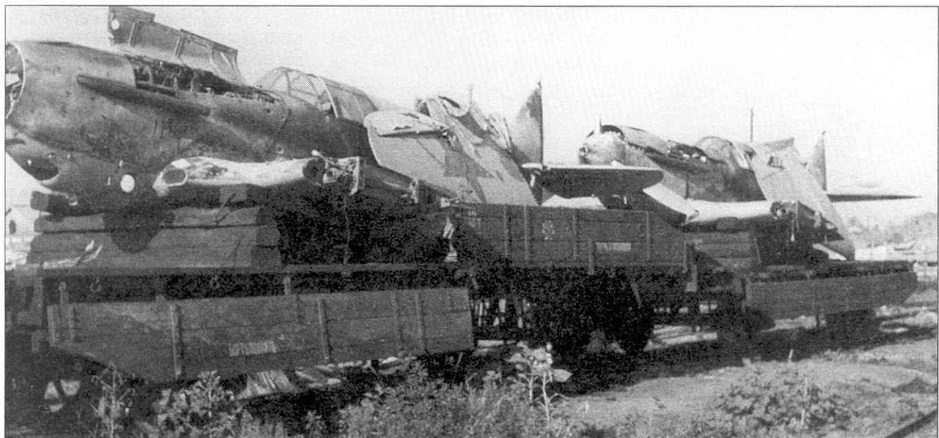
Два поврежденных ЛаГГ-3 части вермахта захватили погруженными на железнодорожные платформы. На переднем плане - ЛаГГ-3 первой серии. Воздухозаборники овальной формы в носке центроплана левой плоскости крыла - типичны для машин трех первых производственных серий. На заднем плане - истребитель ЛаГГ-3 3-й или 4-й серии.
