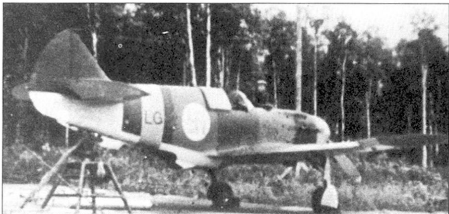
Тот же самый истребитель (заводской номер 0110072) сфотографирован сзади. Самолет имеет камуфляжную окраску из полос черного и оливково-зеленого цветов, нижние поверхности самолета окрашены в светло-голубой цвет. Финны нанесли поверх стандартной окраски ВВС РККА желтые идентификационные полосы вокруг фюзеляжа в носовой и хвостовой частях. Бортовой регистрационный код «LG-2» черного цвета.
