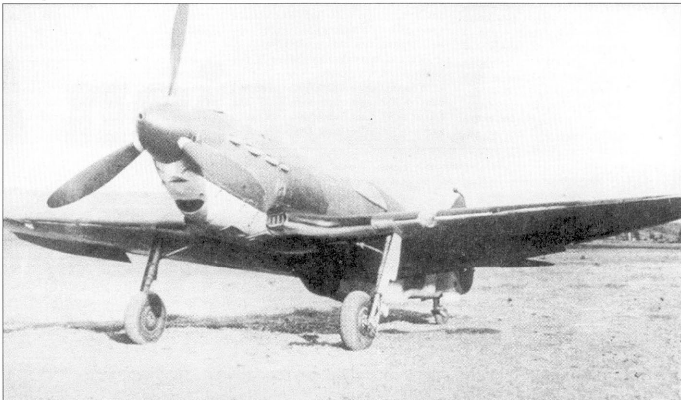
ЛаГГ-3 66-й серии на испытаниях. Обратите внимание на новые воздухозаборник овального сечения в центроплане крыла. В левой плоскости крыла установлена посадочная фара, на серийных самолетах ЛаГГ-3 66-й серии посадочных фар не имелось.
