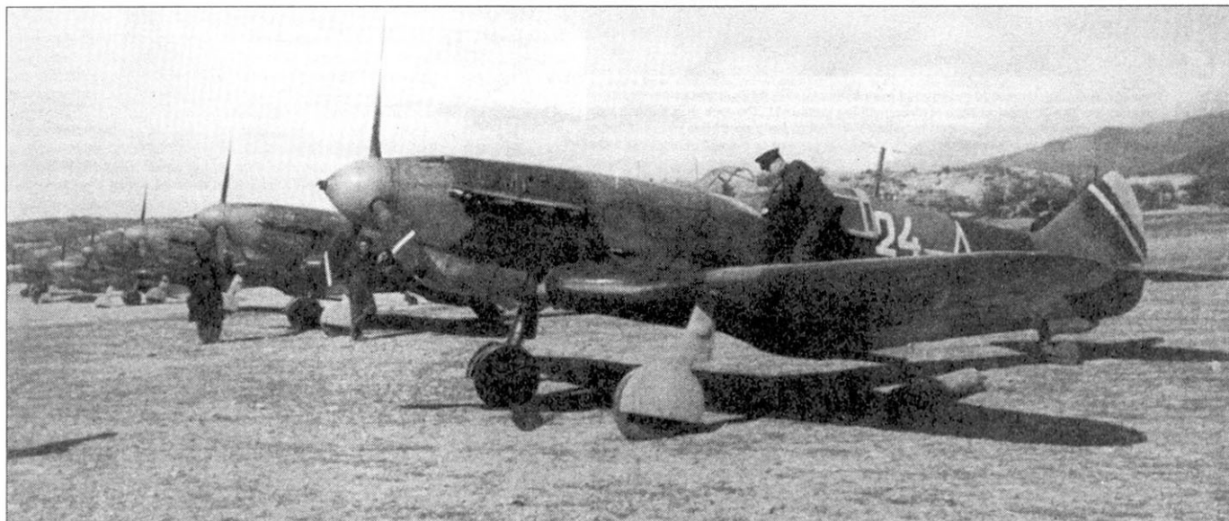
Линейка ЛаГГ-3 66-й серии из 9-го истребительного авиационного полка ВВС Черноморского флота. На лопастях воздушных винтов нанесены тонкие полоски белого цвета. По короткой мачте радиоантенны и четырем выхлопным патрубкам можно определить, что это истребители одной из последних производственных серий.
