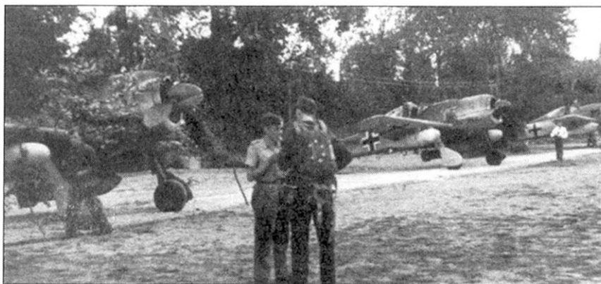
Звено фокке-вульфов подготовлено к боевому вылету, под плоскостями крыльев подвешены дополнительные топливные баки, под фюзеляжем - бомбы.
