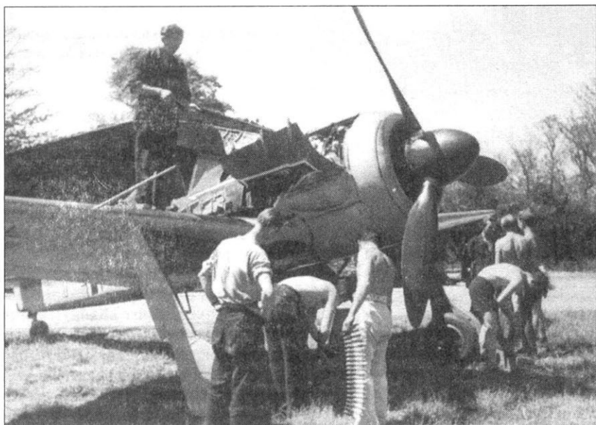
Подготовка к боевому вылету истребителя Fw-190A из III./JG-2. Хорошо видны фрагменты нарисованного на борту фюзеляжа головы орла. Черная эмблема имела функциональное назначение - на ее фоне был не так заметен нагар от выхлопов двигателя BMW-801.
