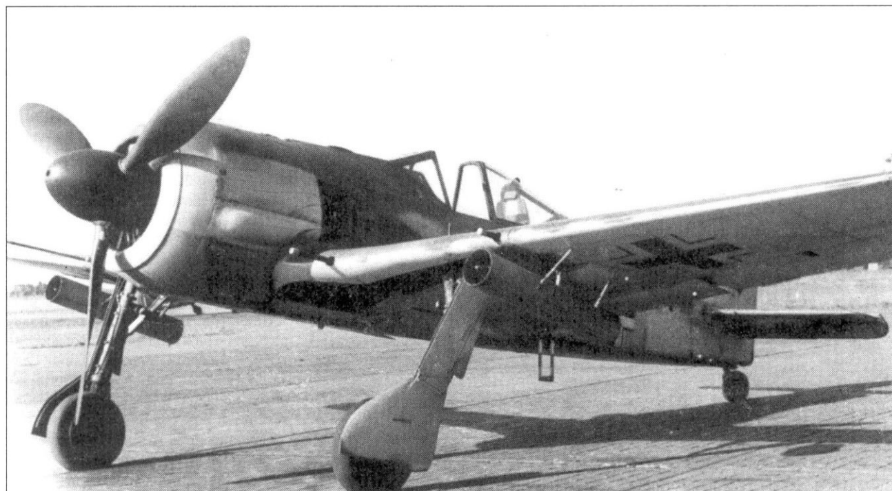
Истребитель Fw-190A-4/R6, под плоскостями крыла подвешены пусковые установки 210-мм снарядов, самолет принадлежал 26-й эскадре, снимок начала 1943 г.
